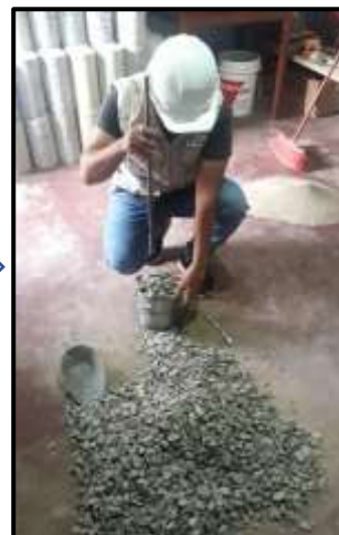
Varillado en tres capas de 25 golpes
