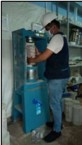
Rotura de los especímenes de concreto
