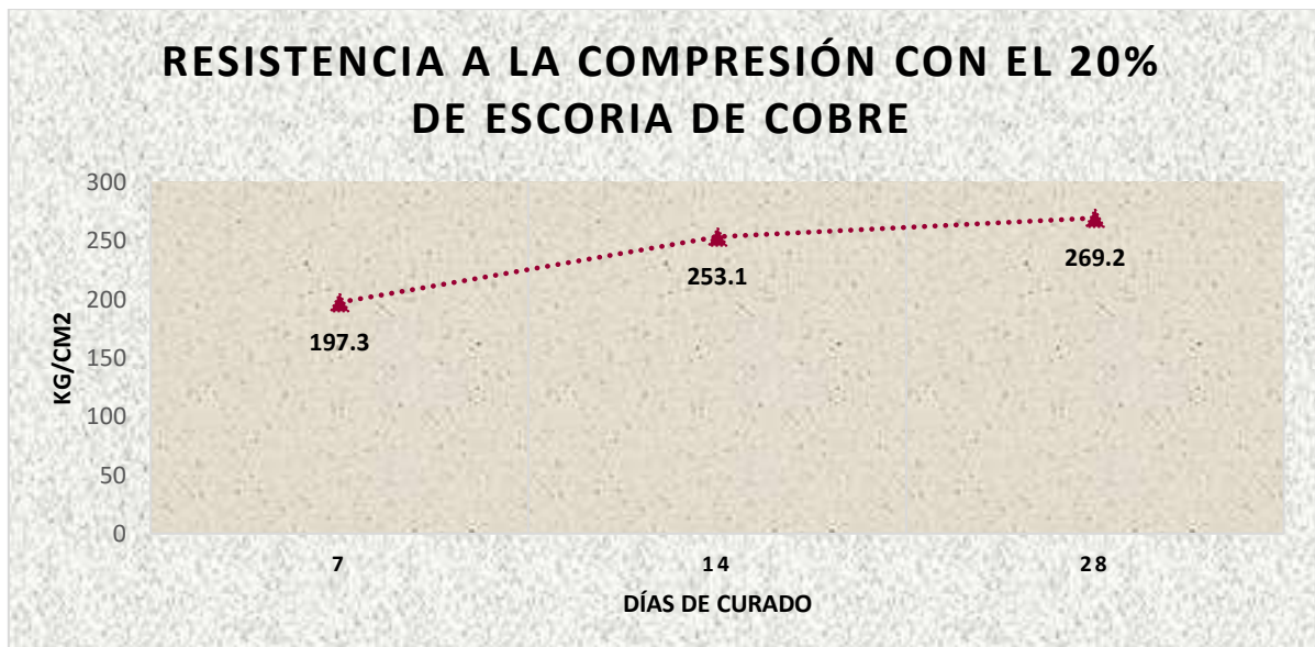
Figura 4: Gráfico de la resistencia a compresión del concreto con la adición del 20% de escoria de cobre.
