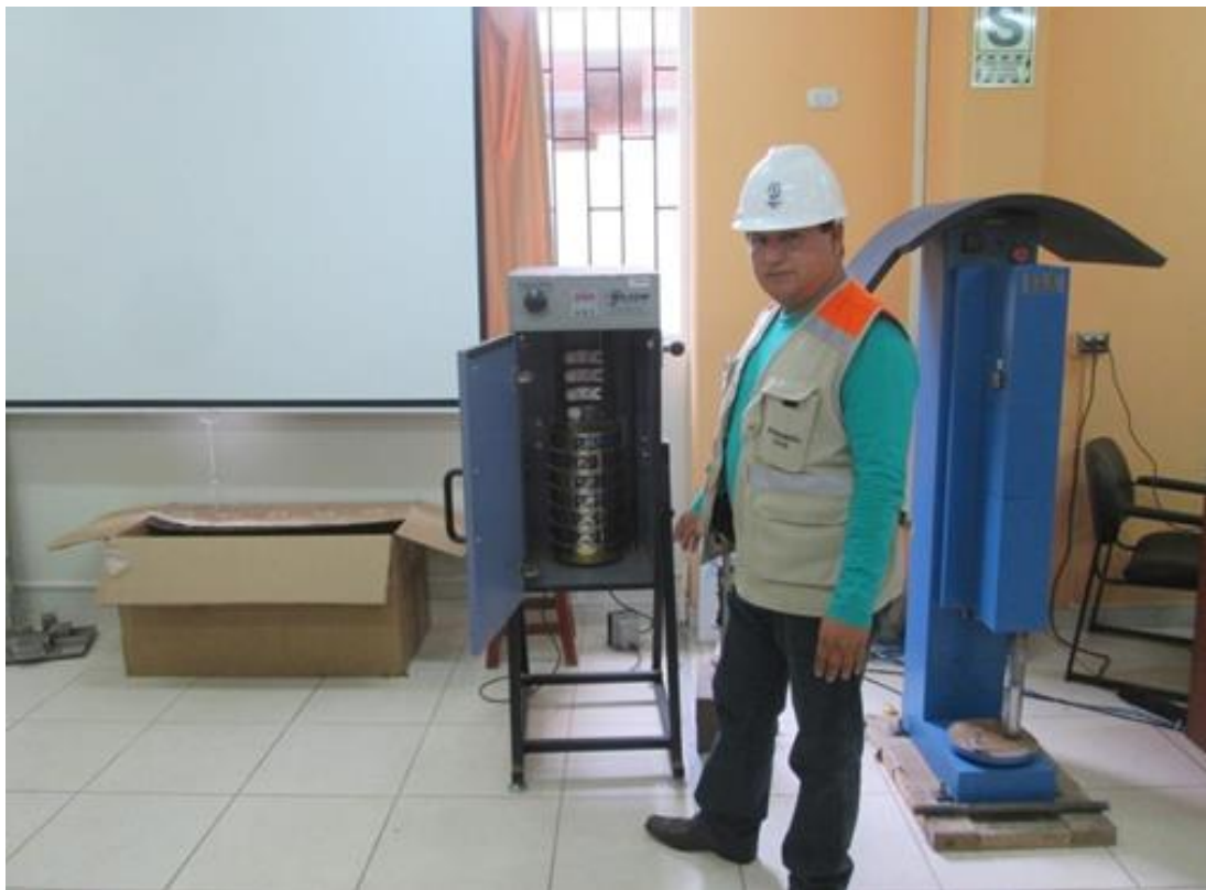
Fotografía 29: Mallas ASTM con material arena, colocadas en el removedor automático. Ensayo de Análisis Granulométrico por Tamizado ASTM D-422 /NTP 339.128
