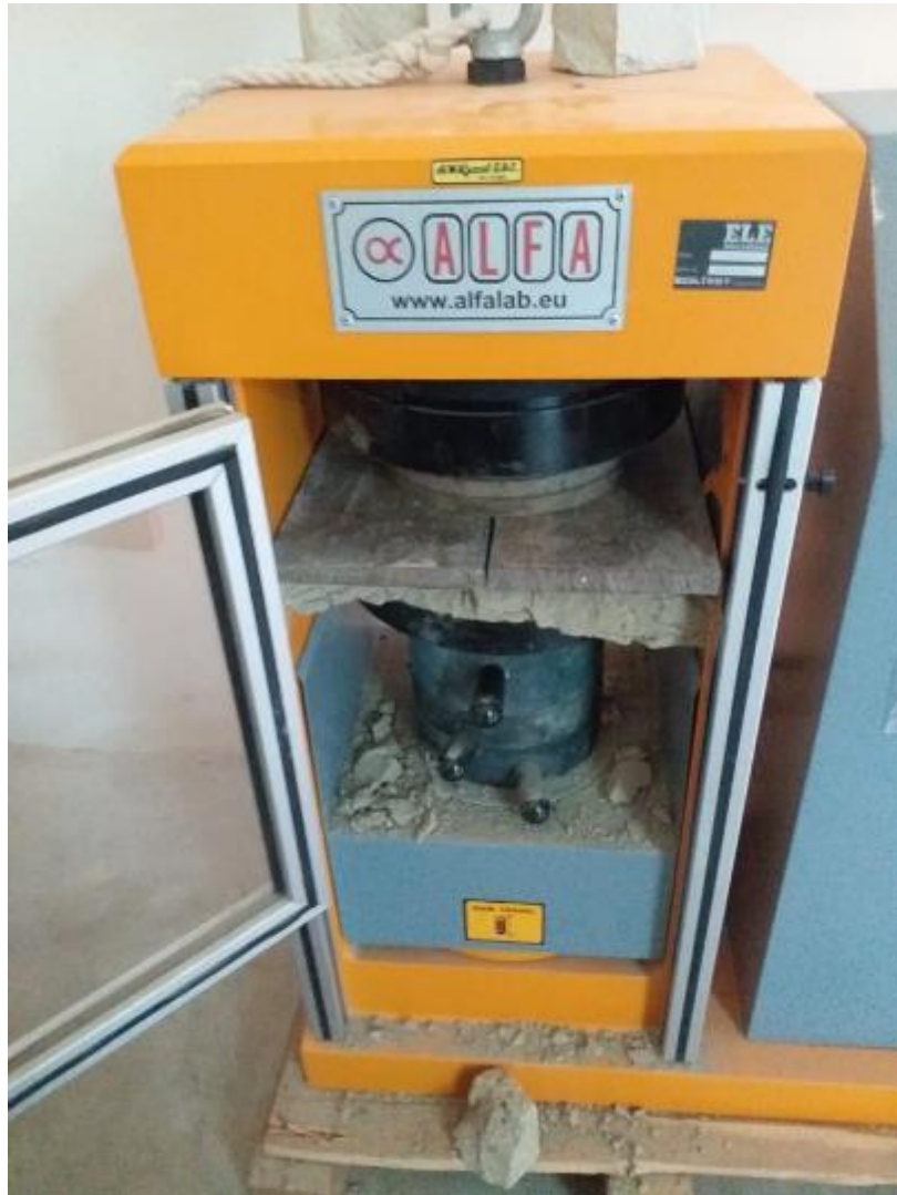
Fotografía 31: Fractura del bloque de adobe
