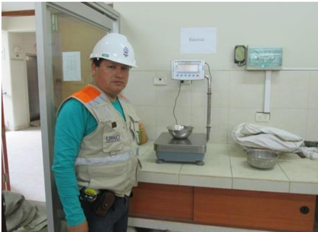
Fotografía 30: realizando el peso retenido del material que pasa por otra de las Mallas ASTM, para encontrar el porcentaje retenido, el porcentaje retenido acumulado y el porcentaje que pasa en la malla. Ensayo de Análisis Granulométrico por Tamizado ASTM D-422 /NTP 339.128
