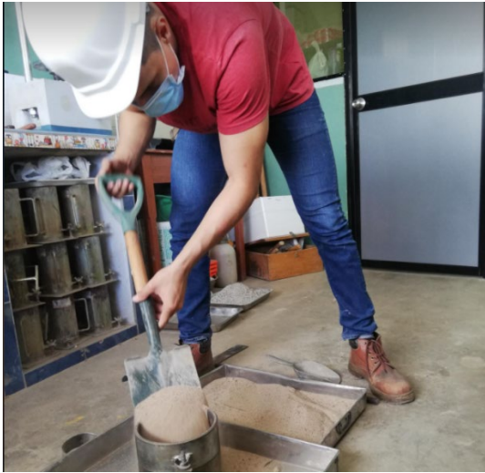
Colocación del agregado fino
