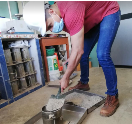
Varillado del agregado grueso en tres capas de 25 golpes.
