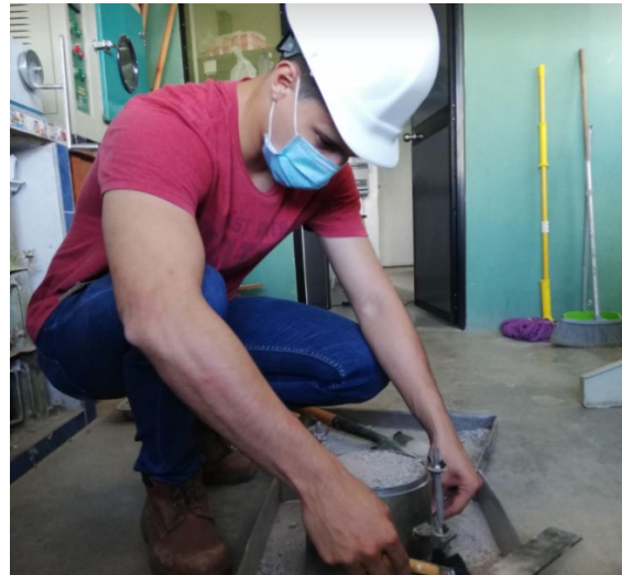
Agregado grueso compactado
