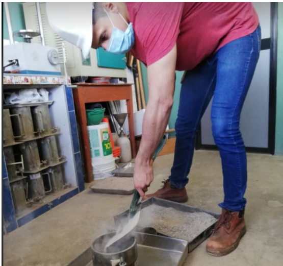
Colocación del agregado grueso.
