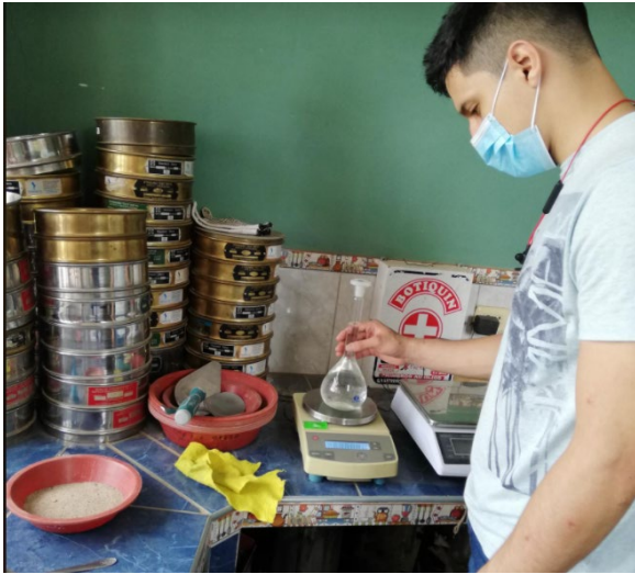
Saturación 24 h – Peso específico y Absorción del agregado grueso.
