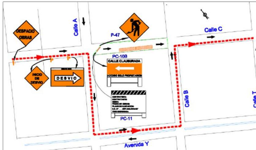
Figura 2: Proceso de Señalización en Obra
