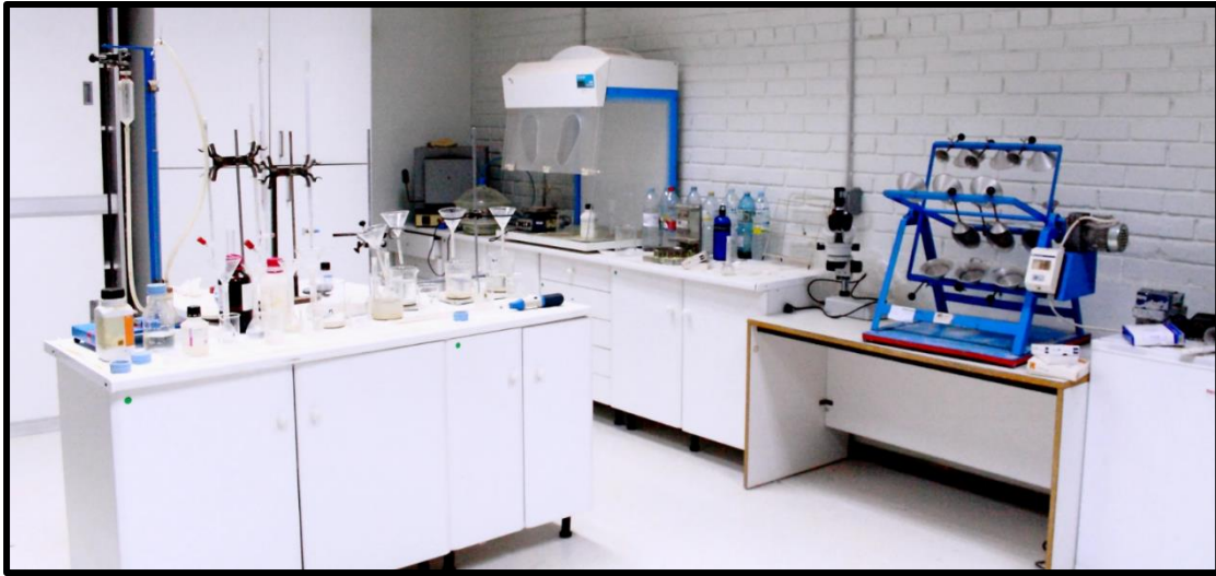
Figura 6 Sala de química con equipo para ensayo de agresividad del suelo.
