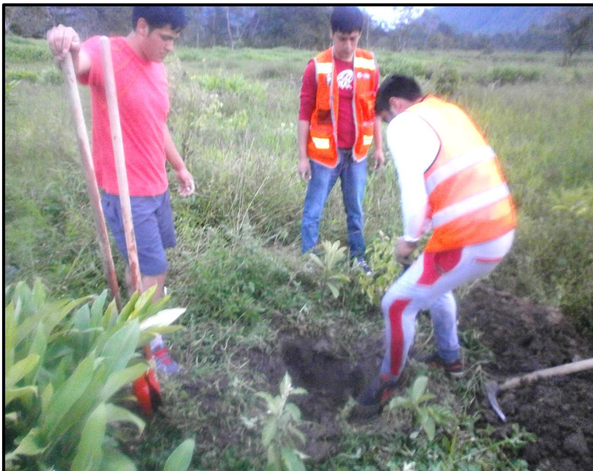
Figura 32 Realización de calicatas – foto 3.
