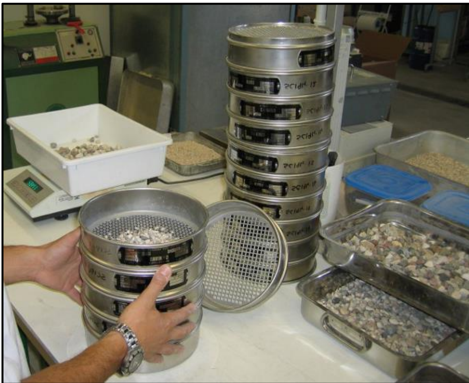
Figura 5 Equipo para ensayo de análisis granulométrico.
