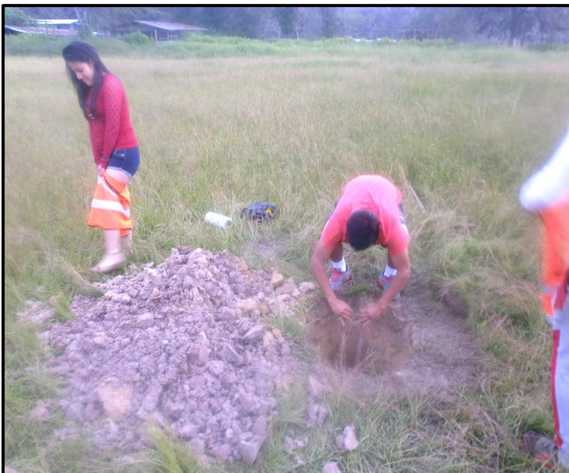
Figura 31 Realización de calicatas – foto 2.
