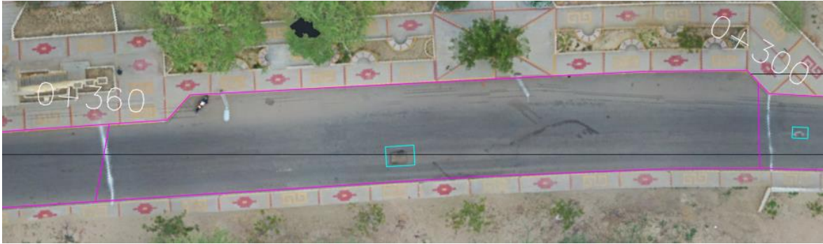
Figura 52. Sección 0+300 - 0+360, Pulimiento de agregados.
