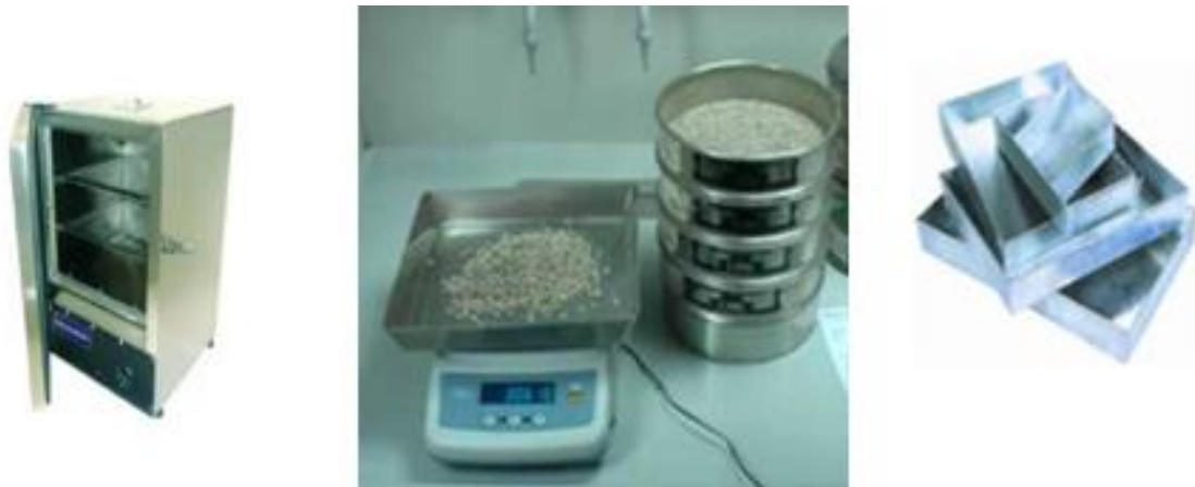
Figura 14: Equipo y herramientas para el ensayo granulometrico.
