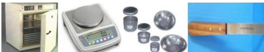
Figura 16: Equipo y herramientas para el ensayo de contenido de humedad.
