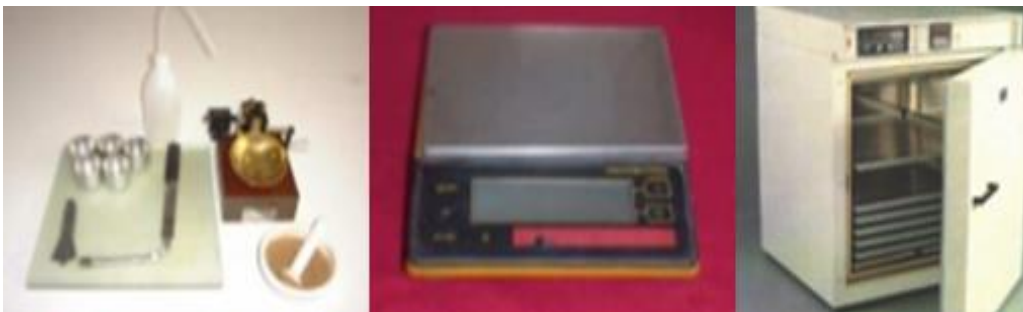
Figura 18: Equipo y herramientas para el ensayo de limite liquido.
