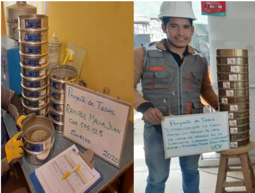
Figura 15: Ensayo de granulometría por tamizado.
