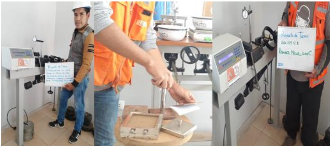
Figura 30: Ensayo de corte directo.
