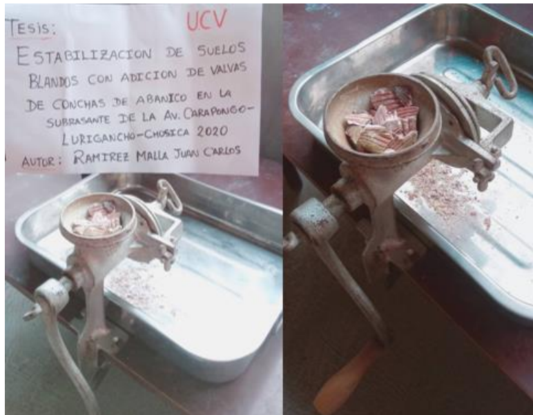
Figura 23: Triturado artesanal de la valva de concha de abanico.
