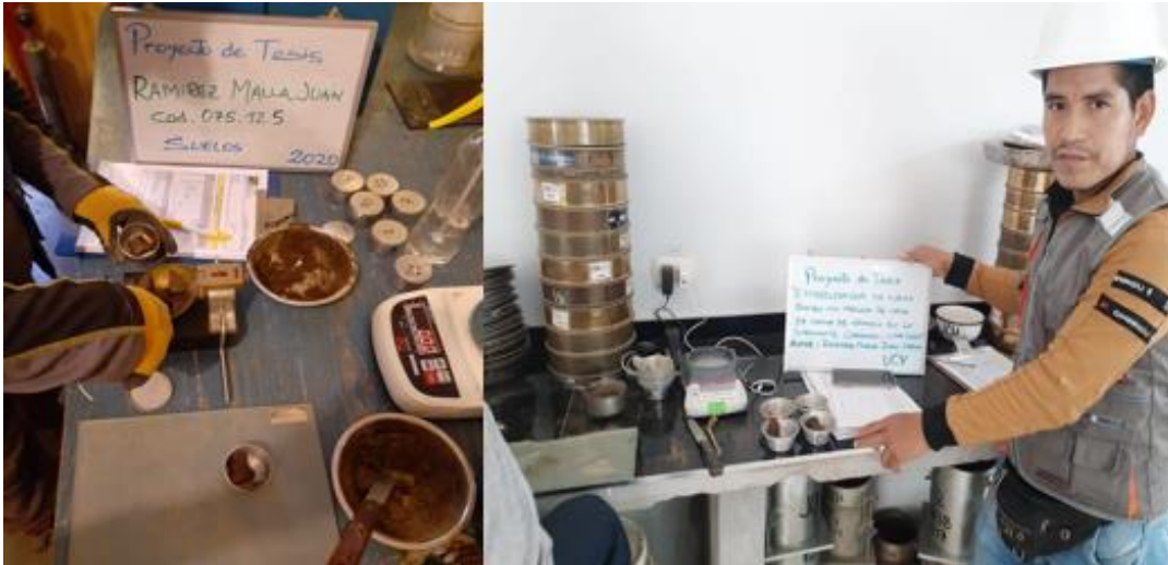
Figura 21: Ensayo de Limite Plastico.
