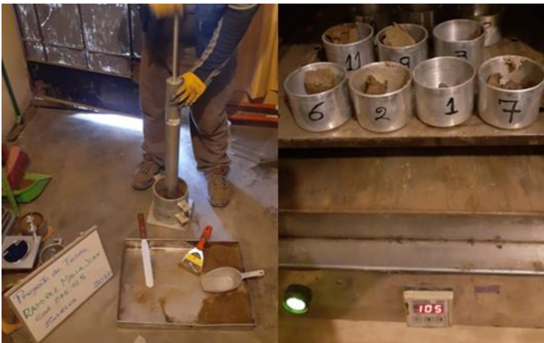
Figura 25: Ensayo de Proctor Modificado.
