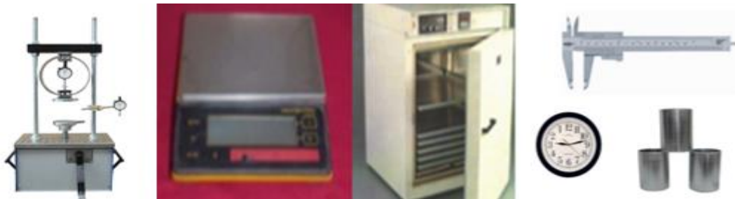
Figura 31: Equipo y herramientas para el ensayo de compresion simple.
