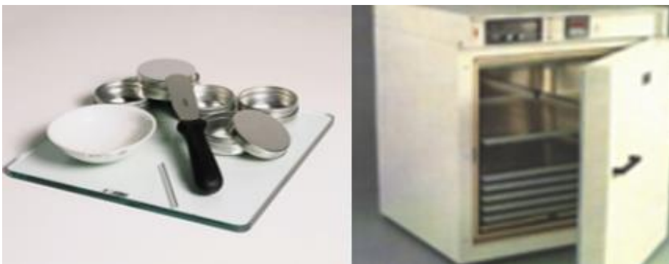
Figura 20: Equipo y herramientas para el ensayo de Limite Plastico.
