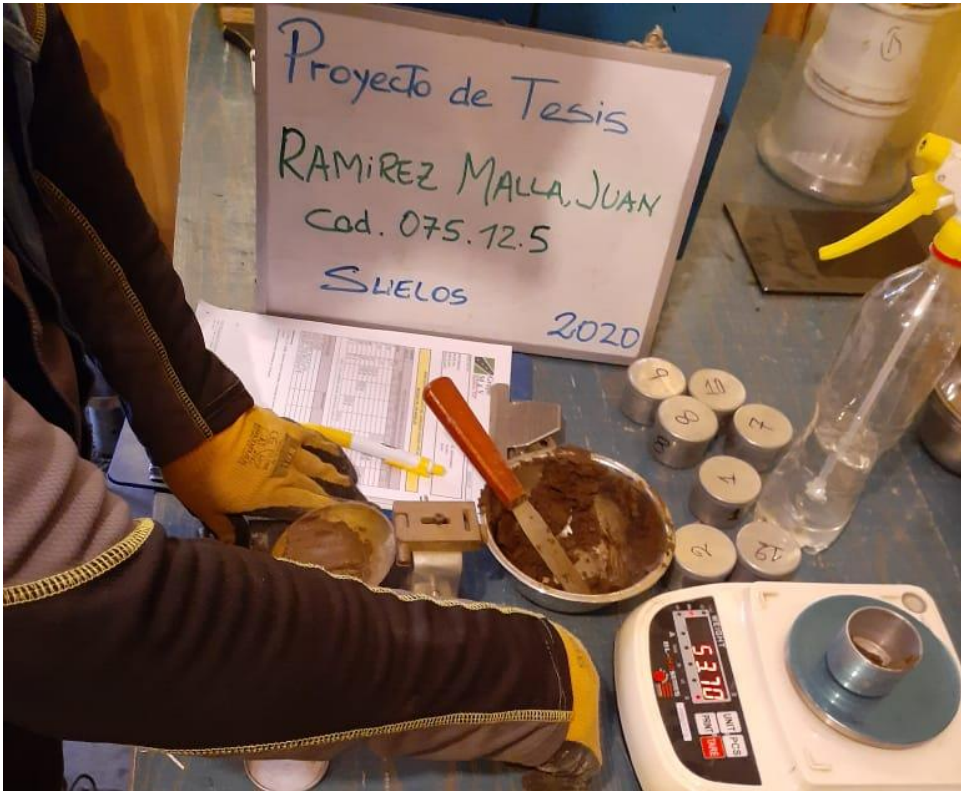
Fuente 19: Ensayo de Límite Líquido.
