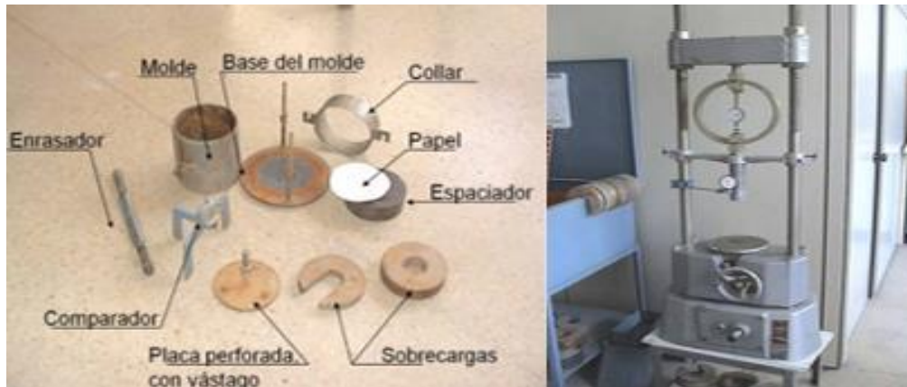
Figura 26: Equipo y herramientas para el ensayo del CBR.
