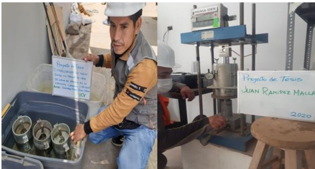
Figura 28: Ensayo del CBR sumergido
