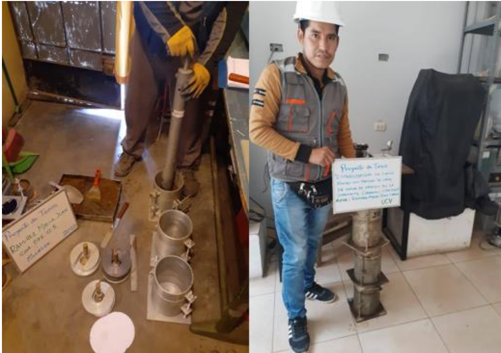
Figura 27: Ensayo del CBR.
