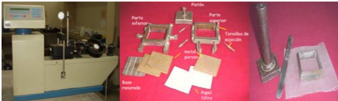
Figura 29: Equipo y herramientas para el ensayo de corte directo.
