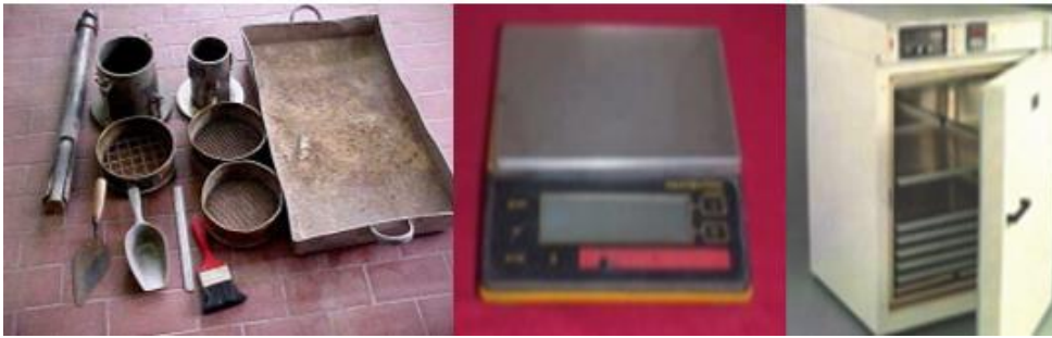
Figura 24: Equipo y herramientas para el ensayo Proctor Modificado.
