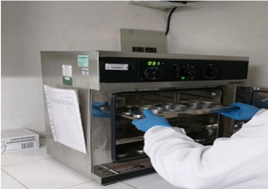
Figura 17: Ensayo de Contenido de Humedad
