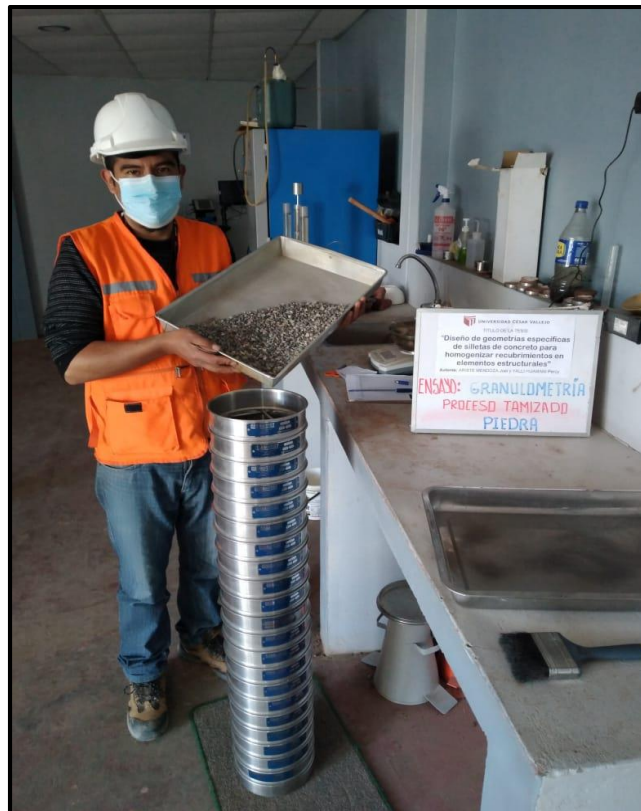
Anexo 3.12: Tamizado del agregado fino
