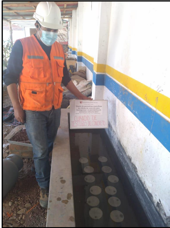
Anexo 3.23: Curado de probetas y silletas
