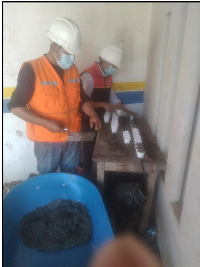
Anexo 3.20: Colocación de concreto en los moldes
