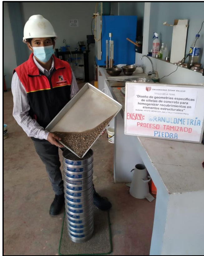
Anexo 3.13: Tamizado del agregado grueso
