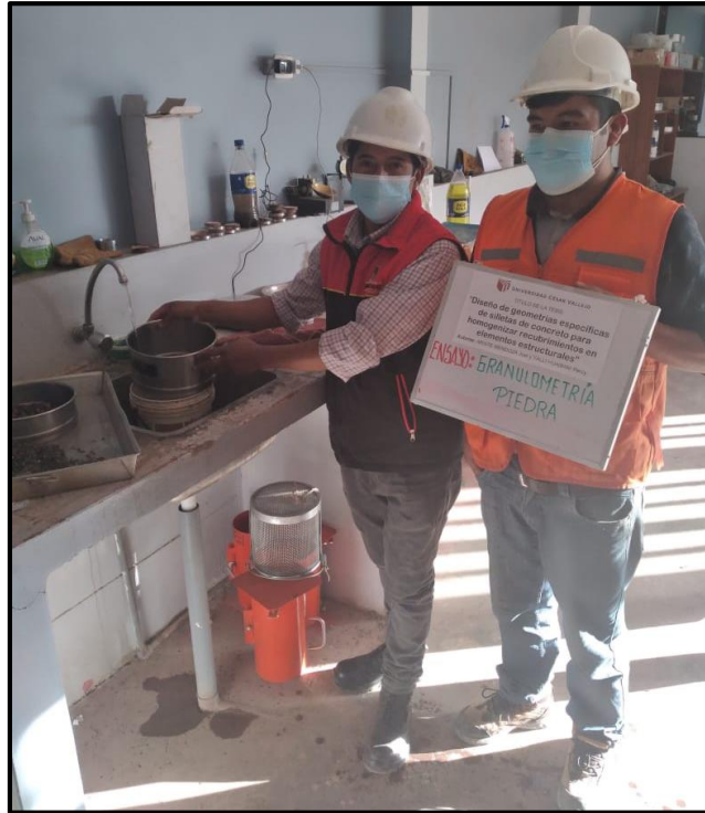
Anexo 3.11: Lavado del agregado grueso
