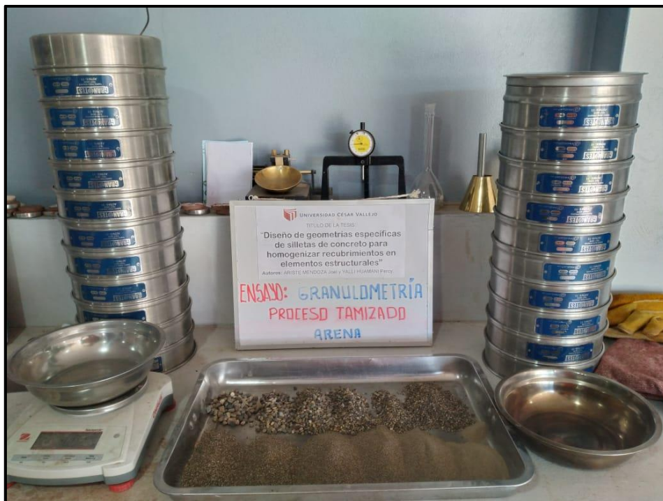
Anexo 3.14: Granulometría del agregado fino
