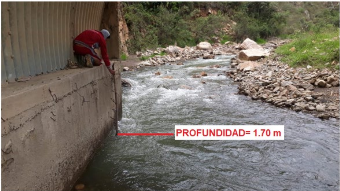
Figura 10. Medición de la profundidad media – Rio Sausicucho
