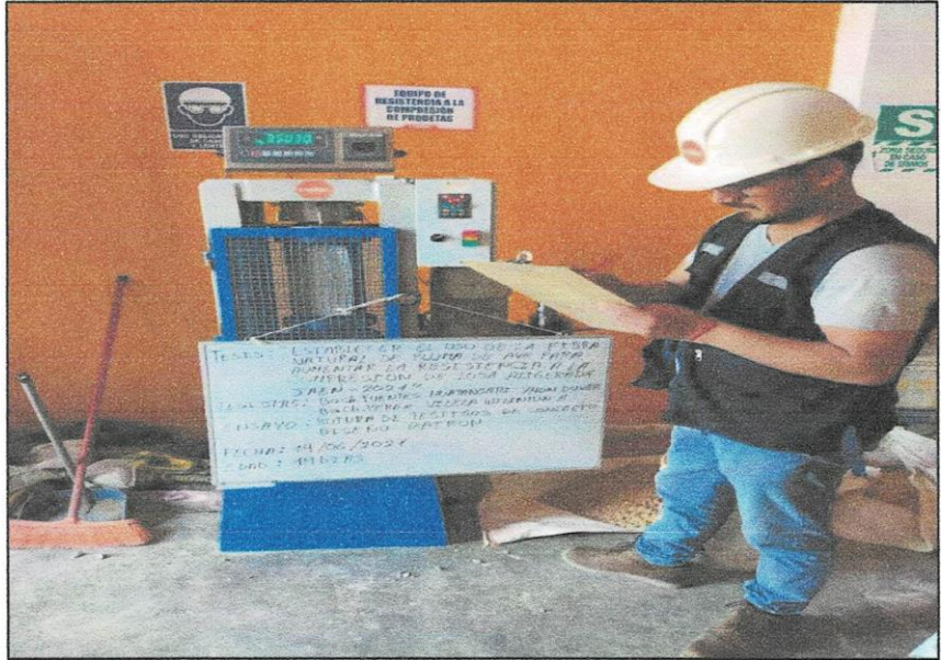
Fotografía N° 05. Toma de datos de los resultados de los ensayos de resistencia a la compresión de probetas.
