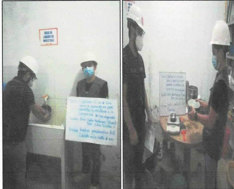
Fotografía N° 07 y 08. Lavado y tamizado de los agregados finos y gruesos.
