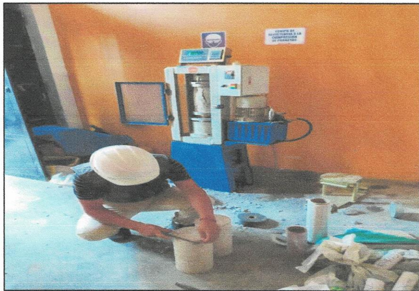
Fotografía N° 02. Identificación de dimensiones de probetas en sus distintos diseños del concreto.
