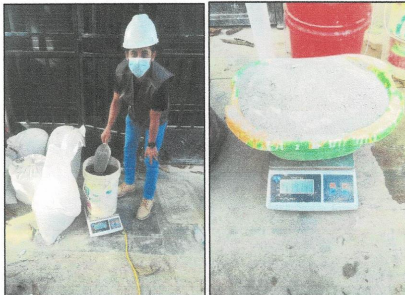
Fotografía N° 17 y 18. Procedemos a pesar los materiales a utilizar para la elaboración de las probetas de concreto.
