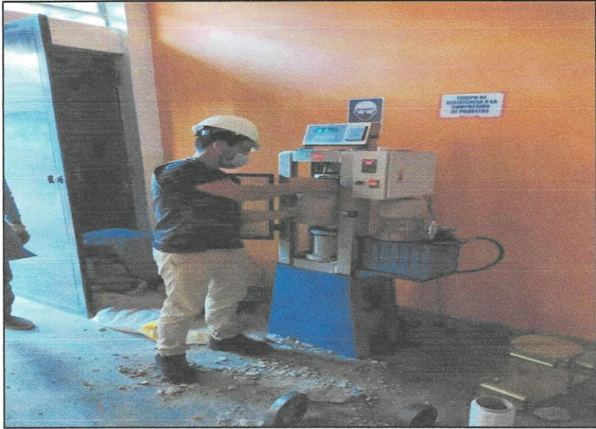
Fotografía N° 03. Colocación de probetas de concreto para su respectivo ensayo de resistencia a la compresión.
