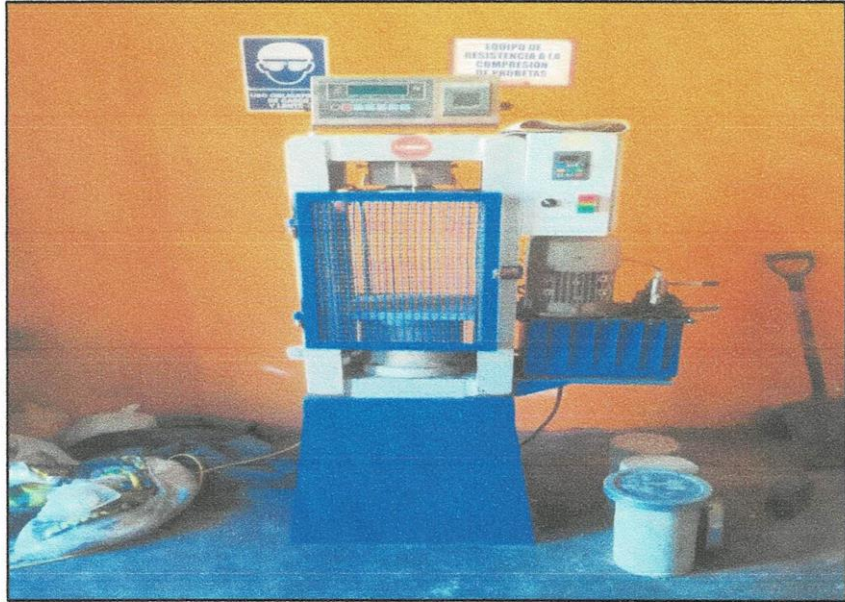
Fotografía N° 01. Prensa hidráulica para ensayos de resistencia a la compresión de testigos de concreto.
