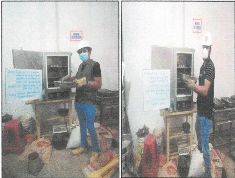
Fotografía N° 05 y 06. Secado del material al horno de 110+- 5° C.
