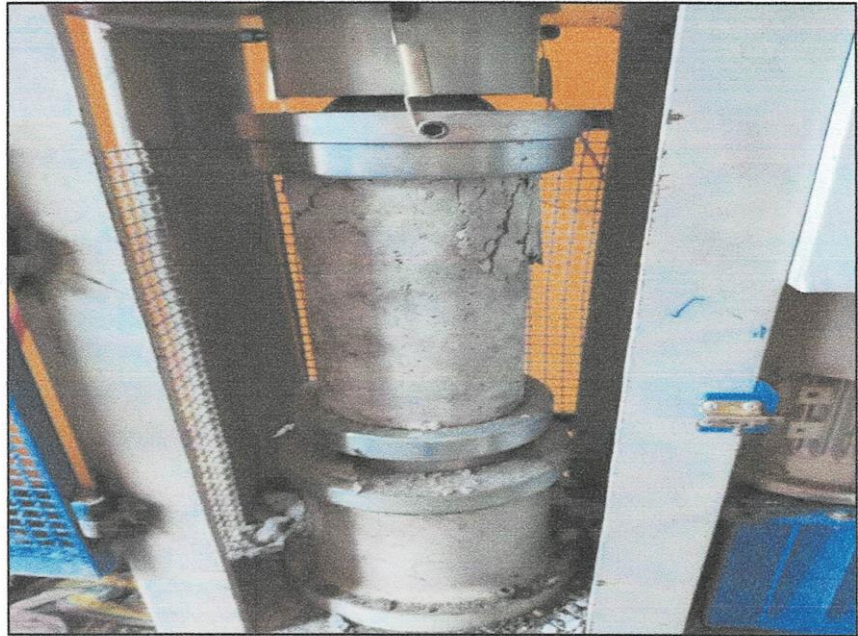
Fotografía N° 06. Resultados de los ensayos de resistencia a la compresión de probetas de concreto.
