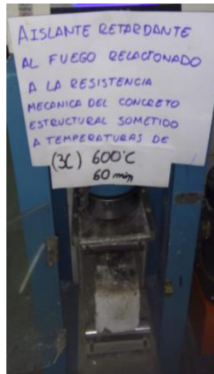
Viga 3 capas expuesta a 600°C a 60 min
