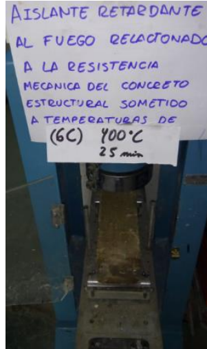
Viga 6 capas expuesta a 400°C a 25 min
