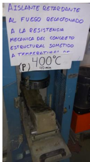
Viga patrón expuesta a 400°C a 40 min
