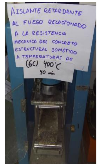
Viga 6 capas expuesta a 400°C a 40 min
