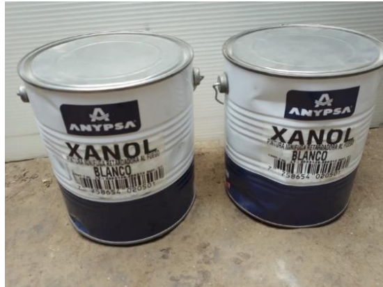
Figura N° 18: : Pintura Ignifuga retardadora al fuego (Aislante)
