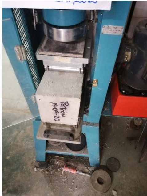
Figura N° 13: Ensayo a flexión viga patrón sin exposición ni recubrimiento
