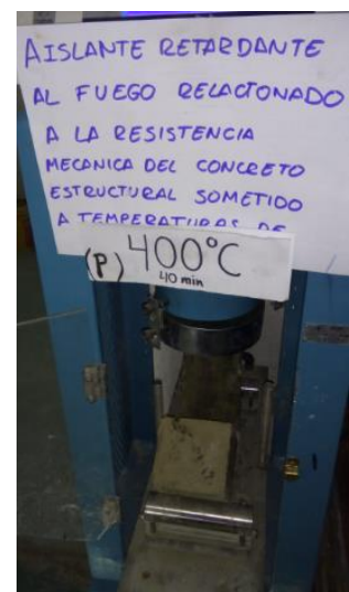
Viga patrón expuesta a 400°C a 40 min
