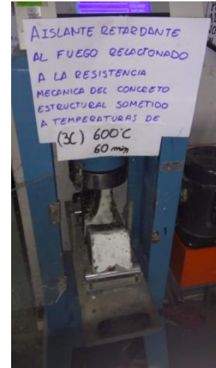
Viga 3 capas expuesta a 600°C a 60 min
