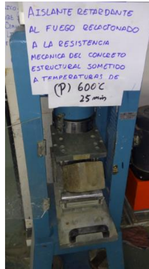
Viga patrón expuesta a 600°C a 25 min
