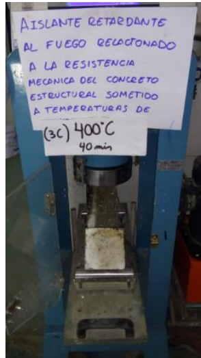
Viga 3 capas expuesta a 400°C a 40 min
