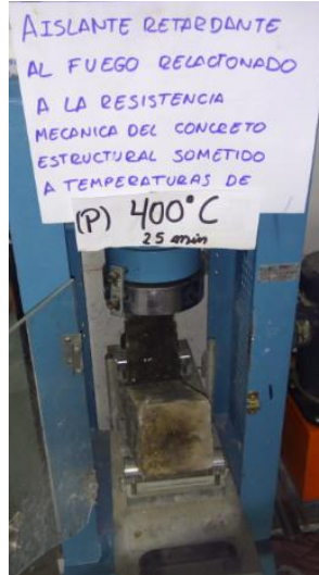
Viga patrón expuesta a 400°C a 25 min a
