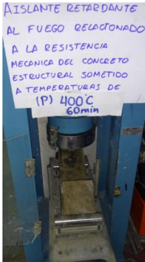
Viga patrón expuesta a 400°C a 60 min
