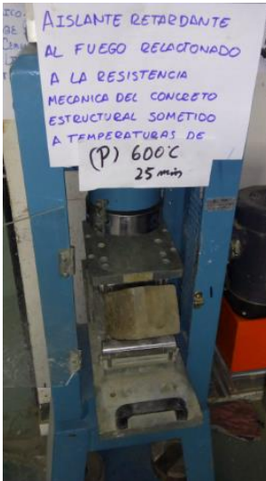
Viga patrón expuesta a 600°C a 25 min
