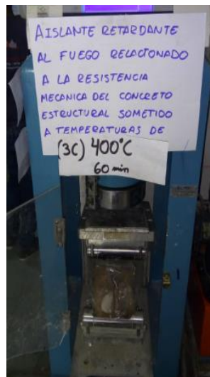
Viga 3 capas expuesta a 400°C a 60 min
