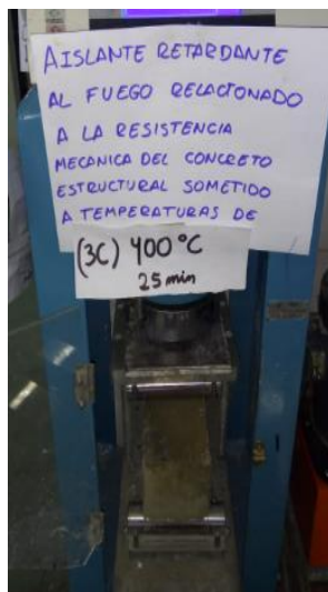
Viga 3 capas expuesta a 400°C a 25 min
