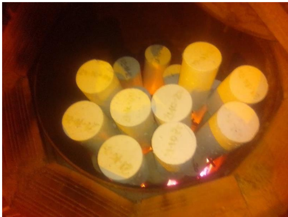
Figura N° 26: Exposición de probetas y vigas al horno artesanal
