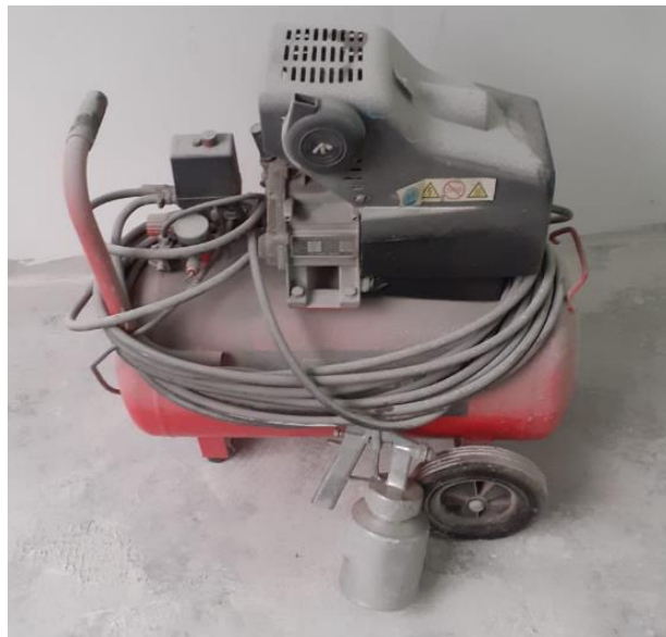
Figura N° 21: Compresora de aire ( Equipo para pintado)
