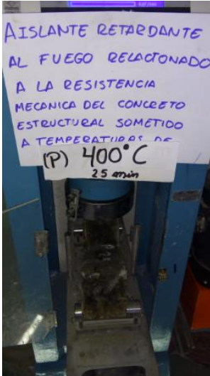
Viga patrón expuesta a 400°C a 25min
