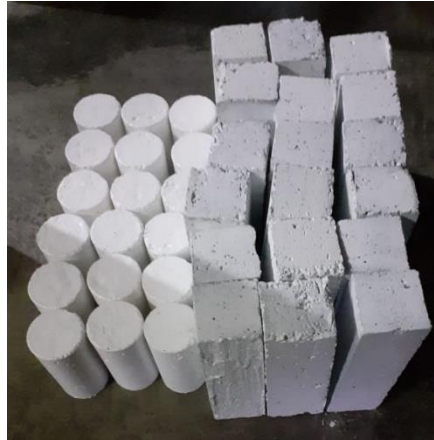
Figura N° 24: Aplicación del aislante en las probetas y vigas
