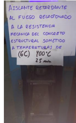
Viga 6 capas expuesta a 400°C a 25 min
