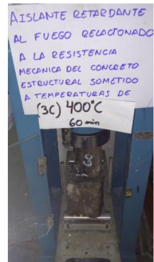
Viga 3 capas expuesta a 400°C a 60 min
