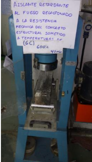
Viga 6 capas expuesta a 600°C a 40 min
