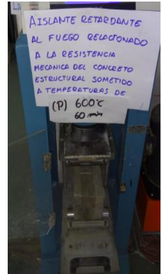
Viga patrón expuesta a 600°C a 60 min
