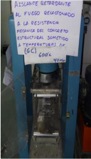
Viga 6 capas expuesta a 600°C a 40 min
