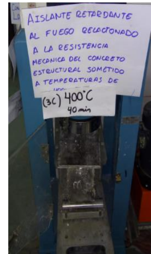
Viga 3 capas expuesta a 400°C a 40 min
