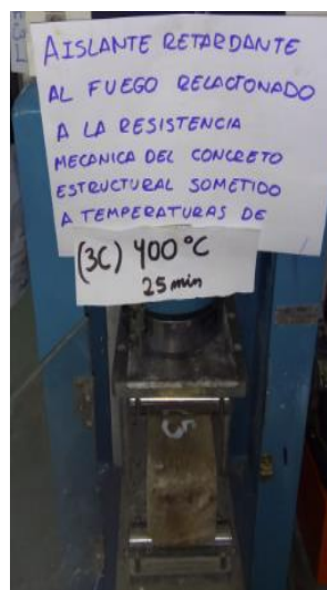
Viga 3 capas expuesta a 400°C a 25 min
