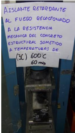
Viga 3 capas expuesta a 600°C a 60 min
