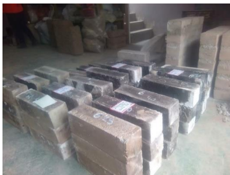
Figura N° 30: Vigas con exposición al fuego
