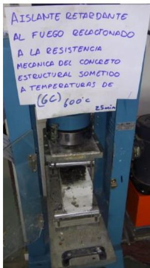
Viga 6 capas expuesta a 600°C a 25 min
