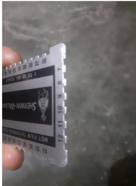
Figura N° 25: Medidor de espesor de capa húmeda de muestras de 3 capas
