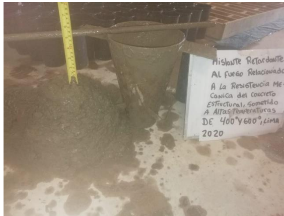
Figura N° 22: Verificación del slump
