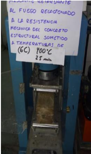
Viga 6 capas expuesta a 400°C a 25 min
