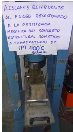
Viga patrón expuesta a 400°C a 60 min
