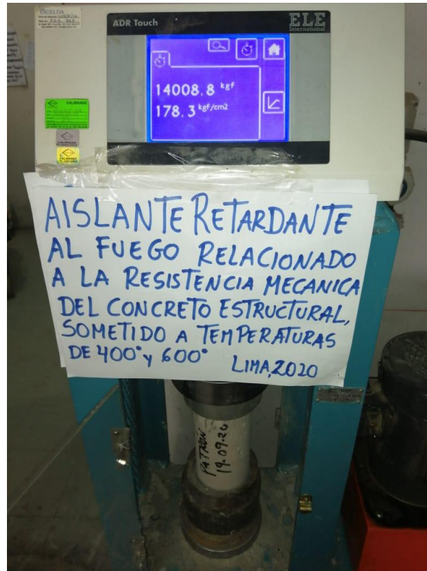
Figura N° 14: Ensayo a compresión de probeta patrón sin exposición
