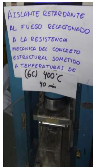
Viga 6 capas expuesta a 400°C a 40 min
