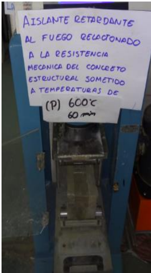
Viga patrón expuesta a 600°C a 60 min
