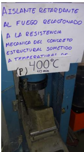
Viga patrón expuesta a 400°C a 40 min
