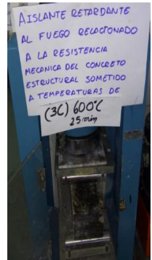
Viga 3 capas expuesta a 600°C a 25 min
