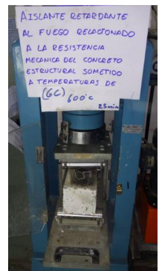
Viga 6 capas expuesta a 600°C a 25 min
