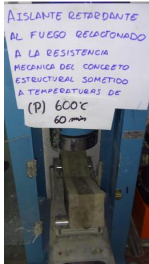
Viga patrón expuesta a 600°C a 60 min
