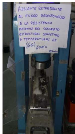
Viga 6 capas expuesta a 600°C a 25 min
