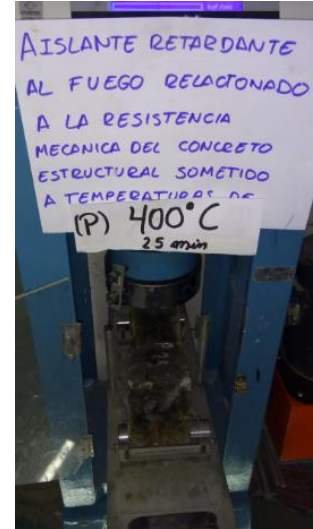
Viga patrón expuesta a 400°C a 25 min
