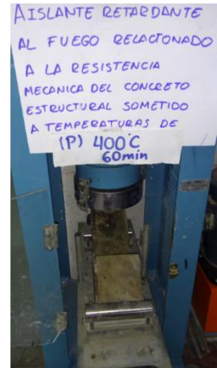
Viga patrón expuesta a 400°C a 60 min
