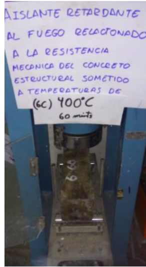
Viga 6 capas expuesta a 400°C a 60 min
