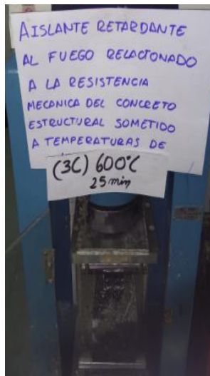
Viga 3 capas expuesta a 600°C a 25 min
