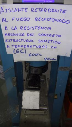
Viga 6 capas expuesta a 600°C a 40 min
