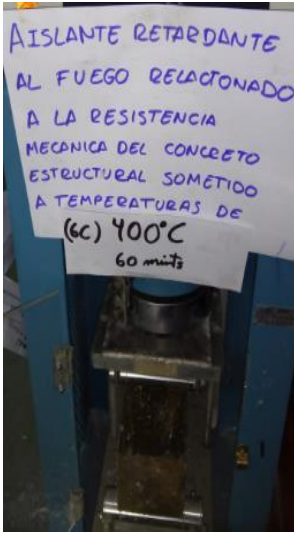
Viga 6 capas expuesta a 400°C a 60 min
