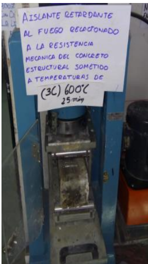
Viga 3 capas expuesta a 600°C a 25 min
