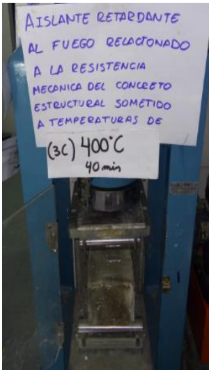
Viga 3 capas expuesta a 400°C a 40 min
