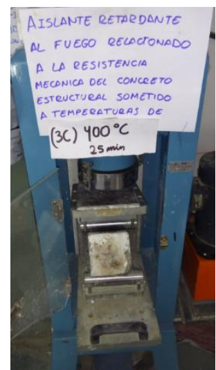
Viga 3 capas expuesta a 400°C a 25 min
