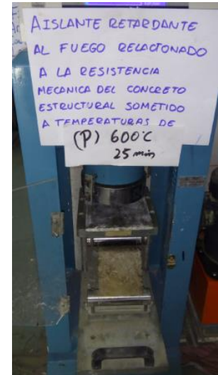
Viga patrón expuesta a 600°C a 25 min
