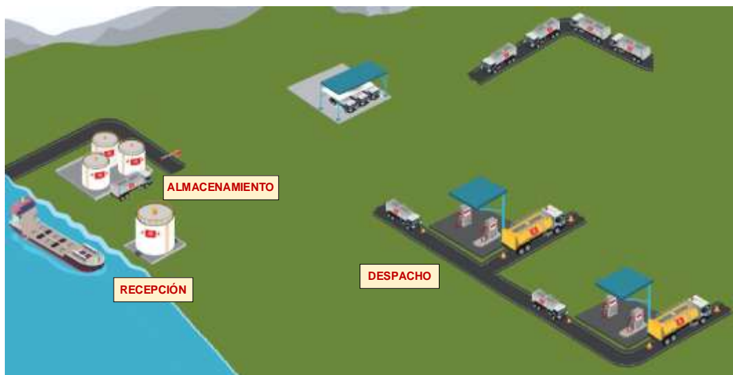
Figura 5: Servicio RAD (Recepción, Almacenamiento y Despacho)
