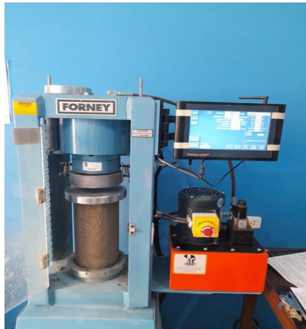
Figura N° 27: Ensayo de resistencia a la compresión M0-0% Pet-Patrón
