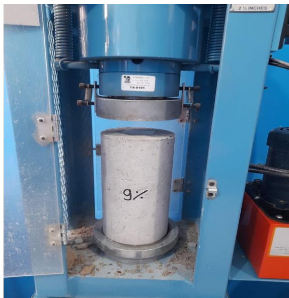
Figura N° 29: Ensayo de resistencia a la compresión M01-9% Pet
