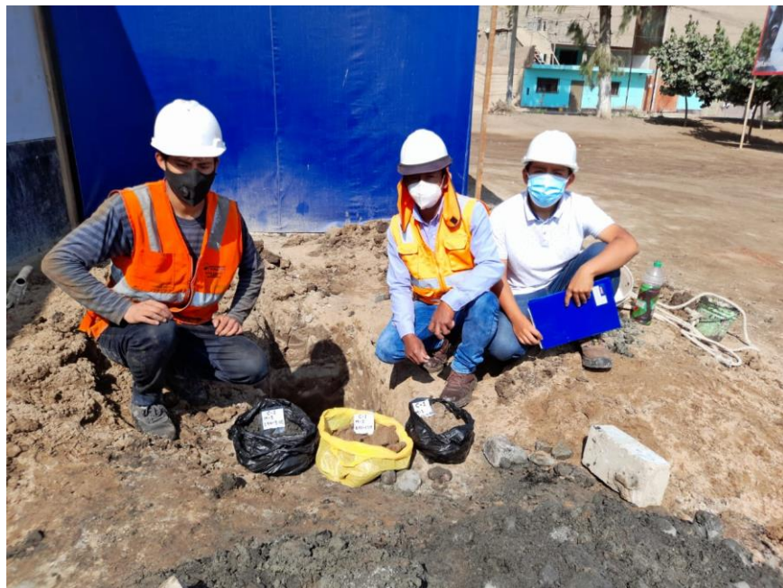
Figura N° 16: Muestreo estratificado de suelos
