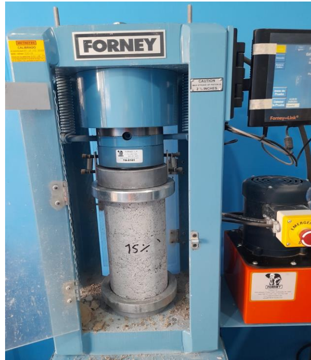
Figura N° 33: Ensayo de resistencia a la compresión M03-15% Pet
