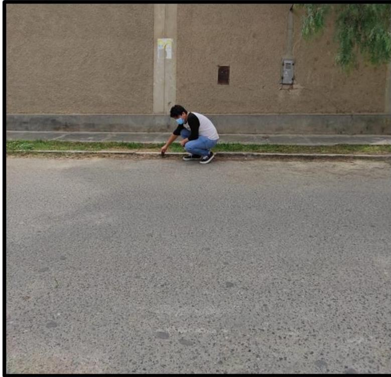
*Figura 26: Medición de ancho de calzada wincha de lona*
