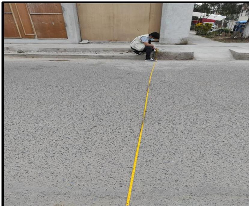
*Figura 27: Medición de falla grieta de borde*
