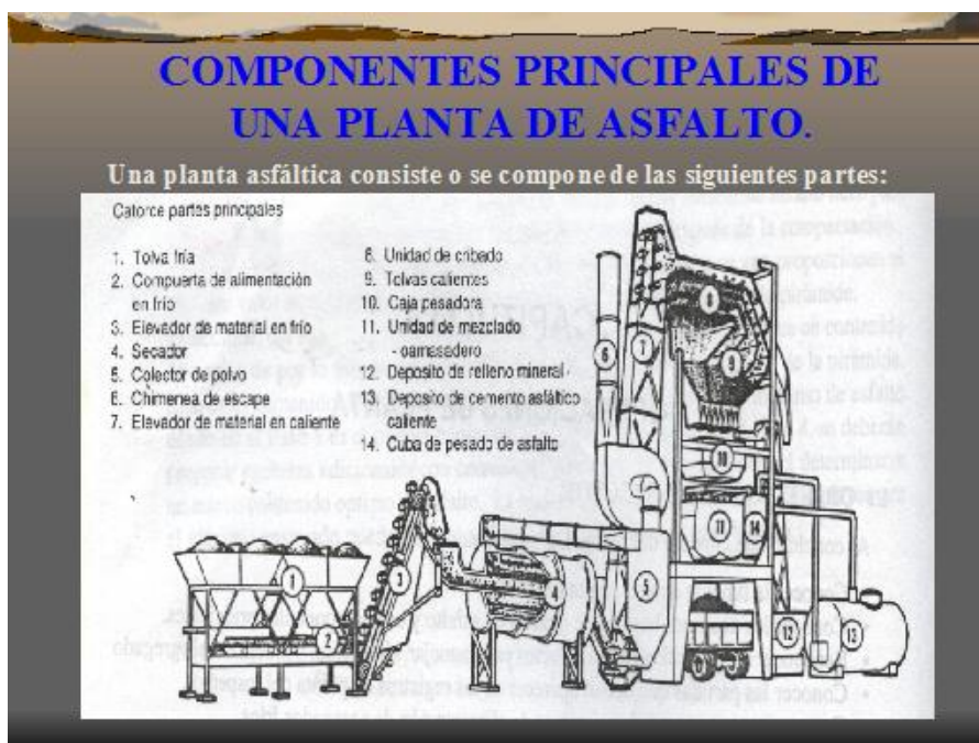
Figura 2: Planta de asfalto con sus respectivos elementos.
