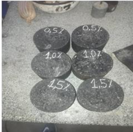
Figura 22. briquetas con mezcla modificada
