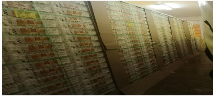
figura 13. túnel lleno con fruta hermetizado con cartón
