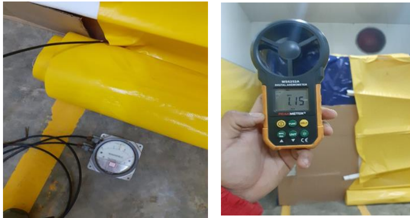
figura 30. anemómetro y vacuómetro instrumentos de medición
