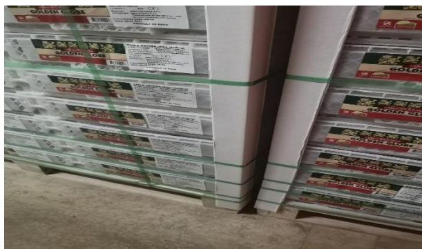
Figura 32. fuga entre pallets dentro del túnel
