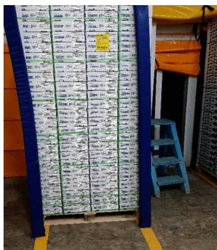
Figura 28. ubicación de colchonetas en pallets dentro del túnel
