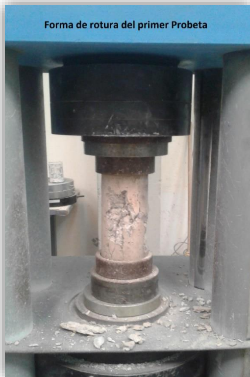
Figura N°14 – Tipo de rotura de la primera probeta.
