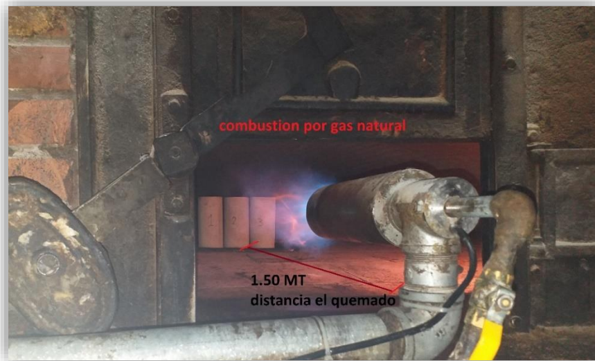
Figura N°7 Probetas sometidas a fuego directo por combustión de gas natural
