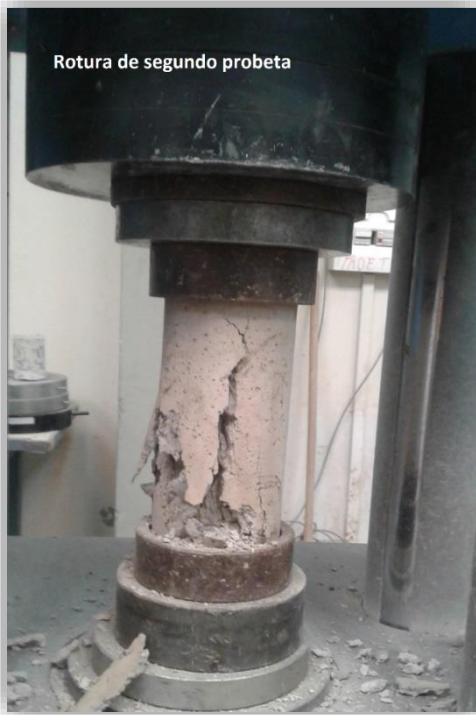
Figura N°16 Tipo de rotura de la segunda probeta.
