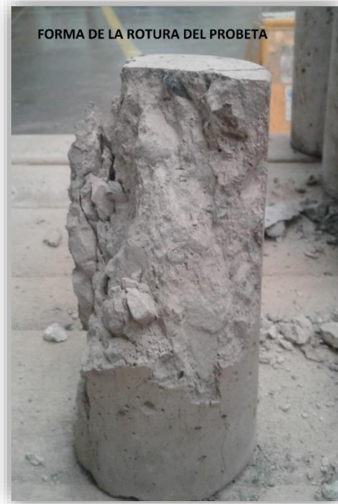
Figura N°16 Tipo de rotura de la segunda probeta.
