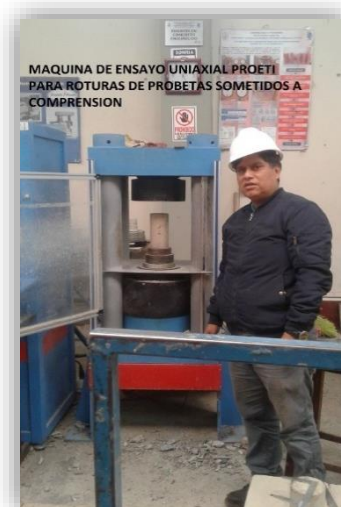
Figura N°11 Ensayo de rotura de las probetas F'c=kg/cm^2
