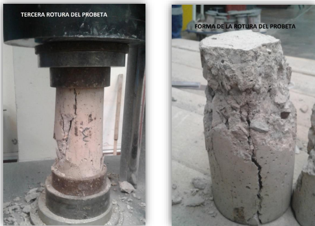
Figura N°18 Tipo de rotura de la segunda probeta.
