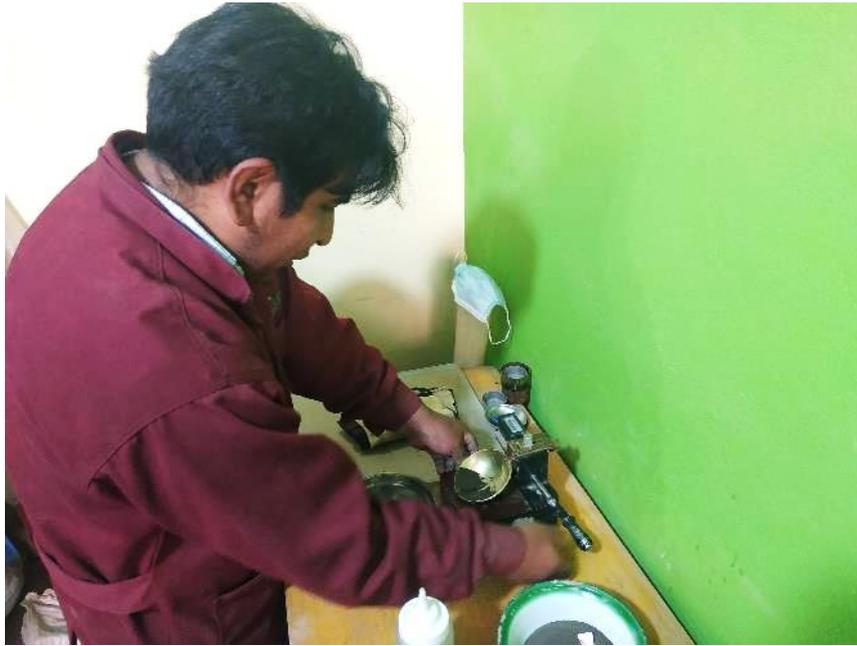
**Fotografía N 03:** Ensayo para determinar en limite liquido en la copa de Casagrande del lodo de aguas residuales.
