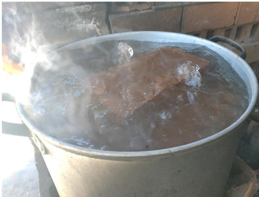
**Fotografía N 10:** Peso del ladrillo saturado en agua caliente durante 3h de ebullición para determinar la densidad, 5 horas de ebullición para determinar la absorción máxima
