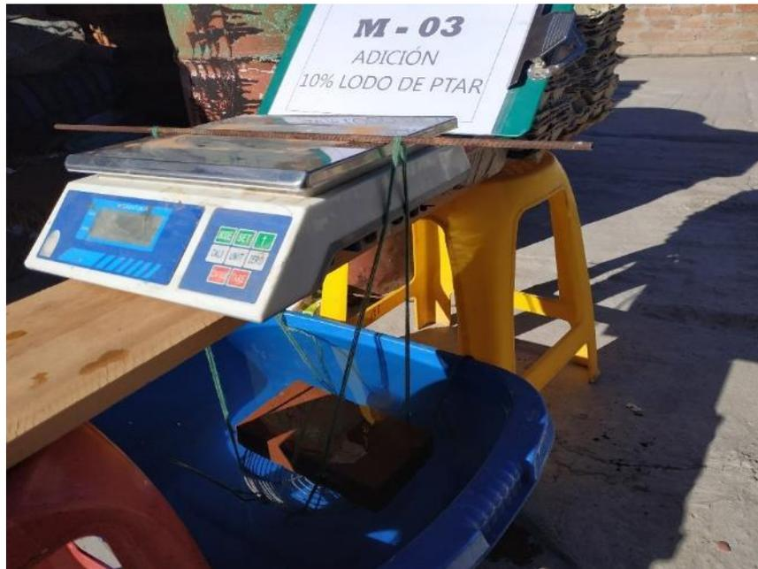
**Fotografía N 11:** Peso Sumergido del ladrillo, después de someter durante 3horas de ebullición para determinar la densidad.
