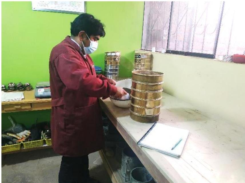
**Fotografía N 02:** Ensayo del análisis granulométrico del lodo de aguas residuales en estado seco y para su posterior ensayo de plasticidad.
