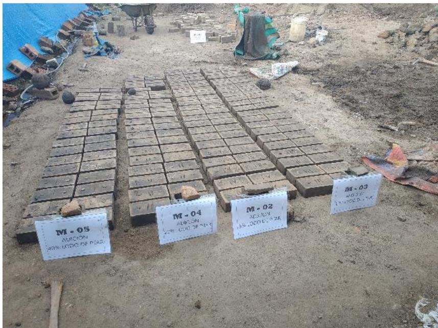
**Fotografía N 06:** Secado de los ladrillos artesanales, codificadas según el tipo de mezcla que corresponde al ladrillo, el secado con una duración de 15 días.
