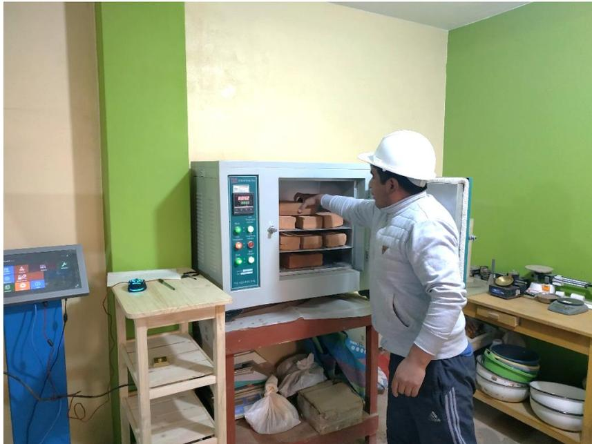
**Fotografía N 09:** Secado en estufa durante 24 horas de los ladrillos para pesar el peso seco para determinar la succión, absorción y densidad.
