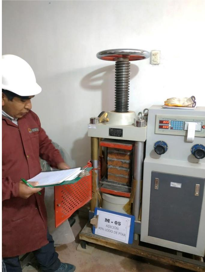
**Fotografía N 15:** Ensayo de resistencia a la compresión uniaxial en pilas
