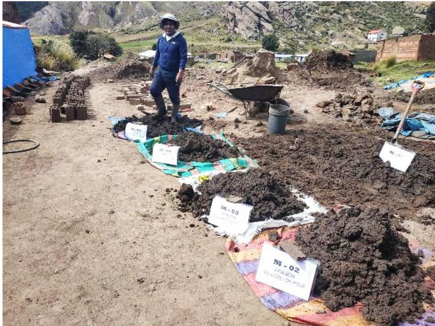
**Fotografía N 05:** Mezclado para diferentes porcentajes de adición (0%, 5%, 10% 20% y 40%) de lodo de aguas residuales con la materia prima utilizada de cantera.
