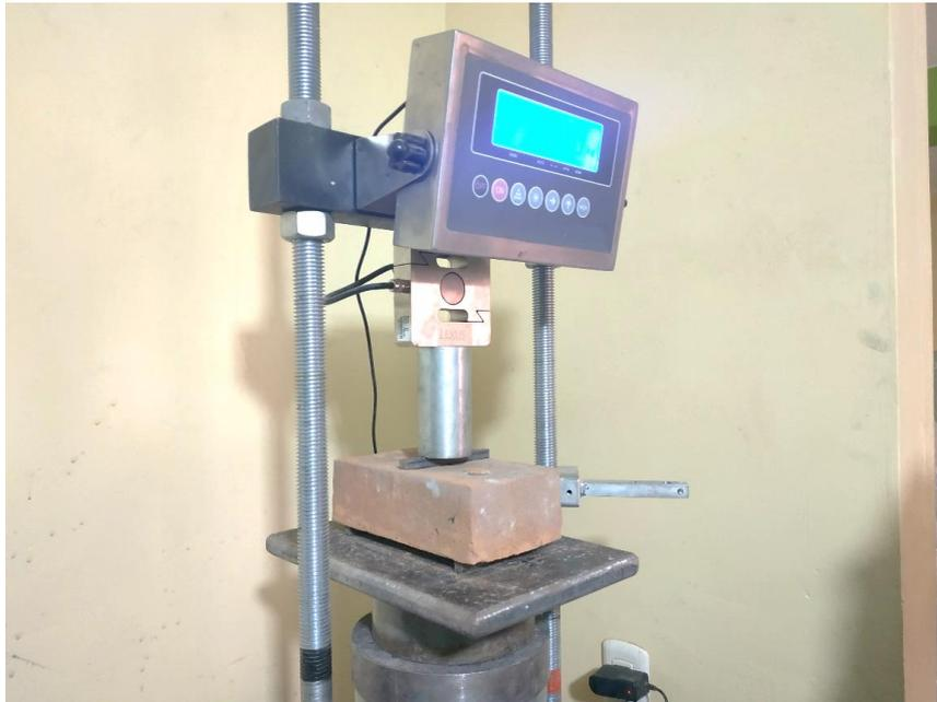
**Fotografía N 13:** Ensayo a la resistencia a la tracción por flexión, colocado encima de dos fieros de 1/2 separados 18cm en la parte inferior y 1 varilla de acero en la parte superior.
