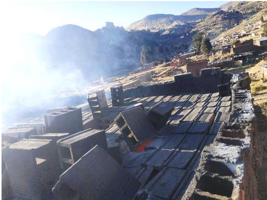
**Fotografía N 08:** Vista desde la parte superior del horno artesanal durante el quemado de los ladrillos artesanales durante 8 Horas.
