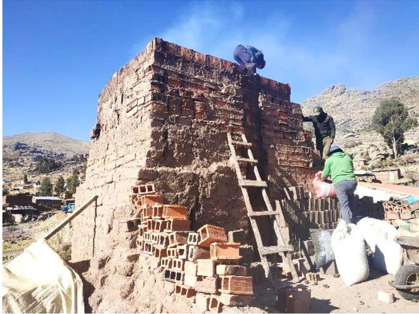
**Fotografía N 07:** Quemado de los ladrillos artesanales en hornos de la Rinconada – C.P. Salcedo - Puno.
