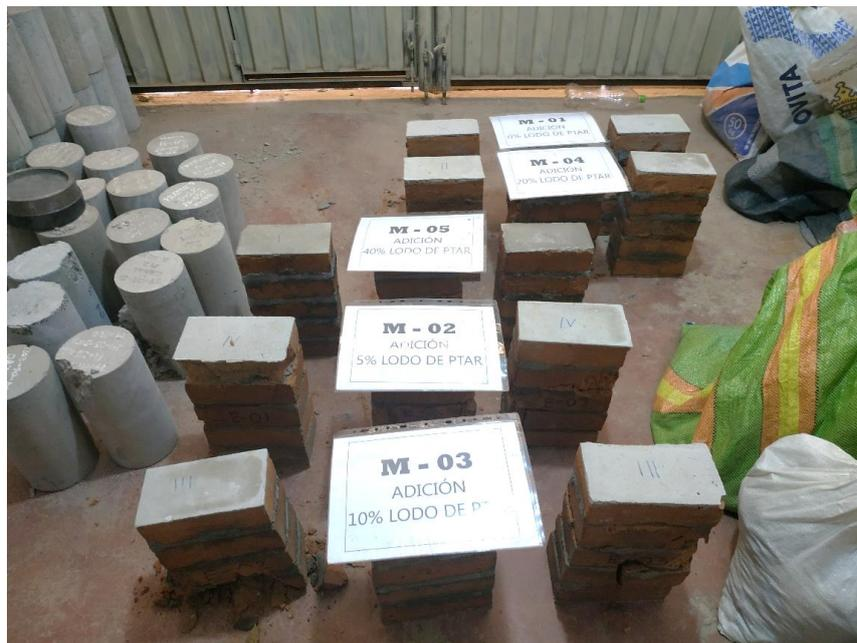
**Fotografía N 16:** Pilas después del ensayo de resistencia a la compresión uniaxial
