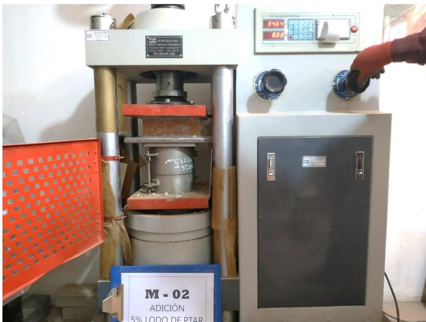
**Fotografía N 14:** Ensayo de resistencia a la compresión axial, en unidades de albañilería
