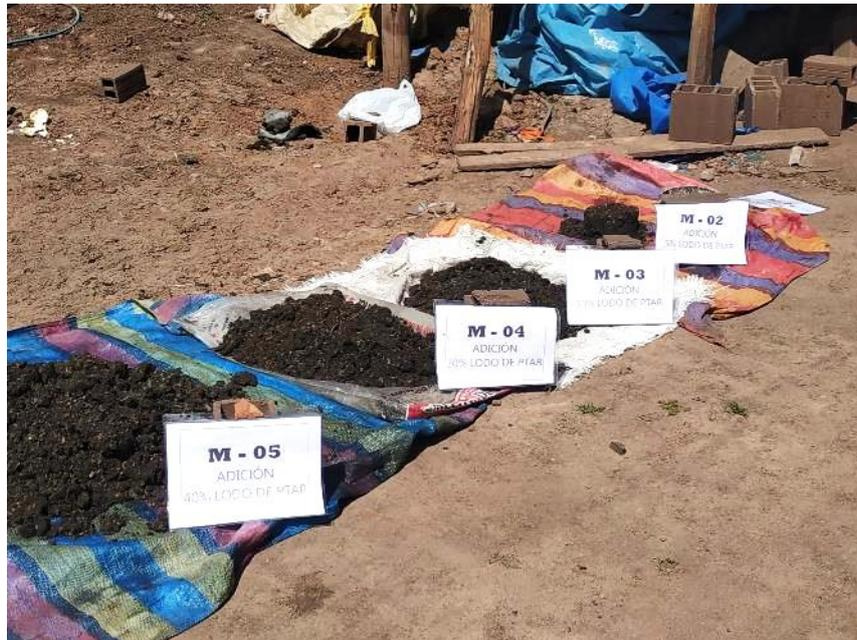
**Fotografía N 04:** Dosificación de lodo en función al volumen de la mezcla en 5%, 10%, 20% y 40% (Centro poblado de Salcedo – la Rinconada– Puno)
