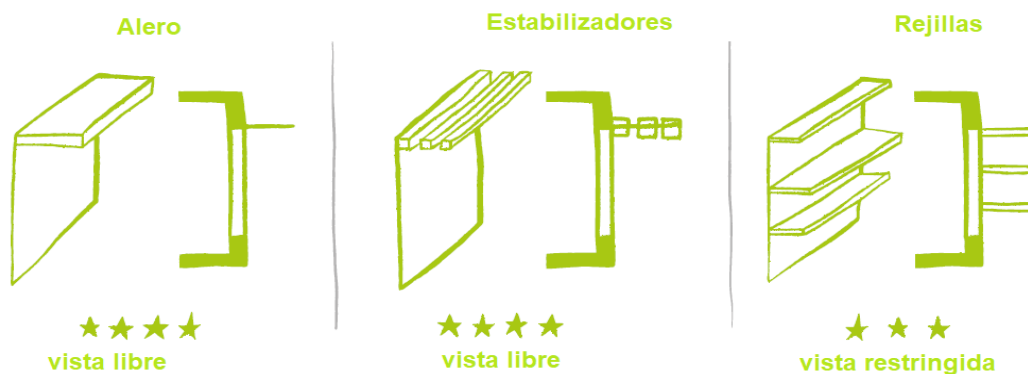
Figura 14. Dispositivos para el control de sol y sombra en exterior de las ventanas.
