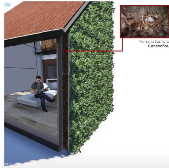
Figura 97. Muro verde térmico canevaflor
