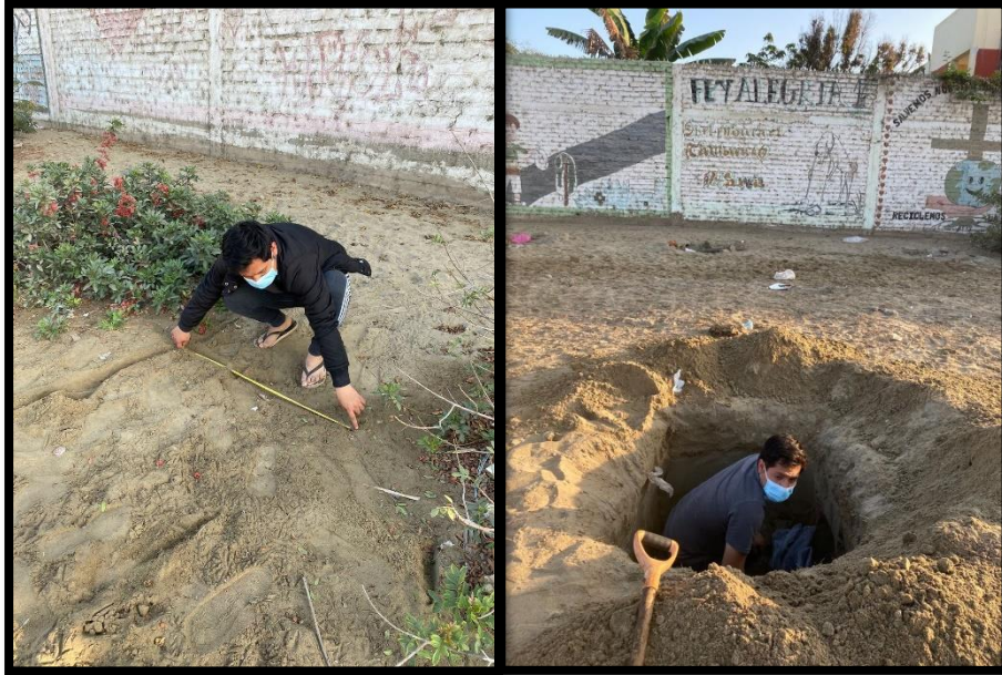
Imagen 1. Se utilizó una sección de 1.00 m de ancho por 1.00m de largo y 1.10 m de profundidad (dando con la capa freática).
