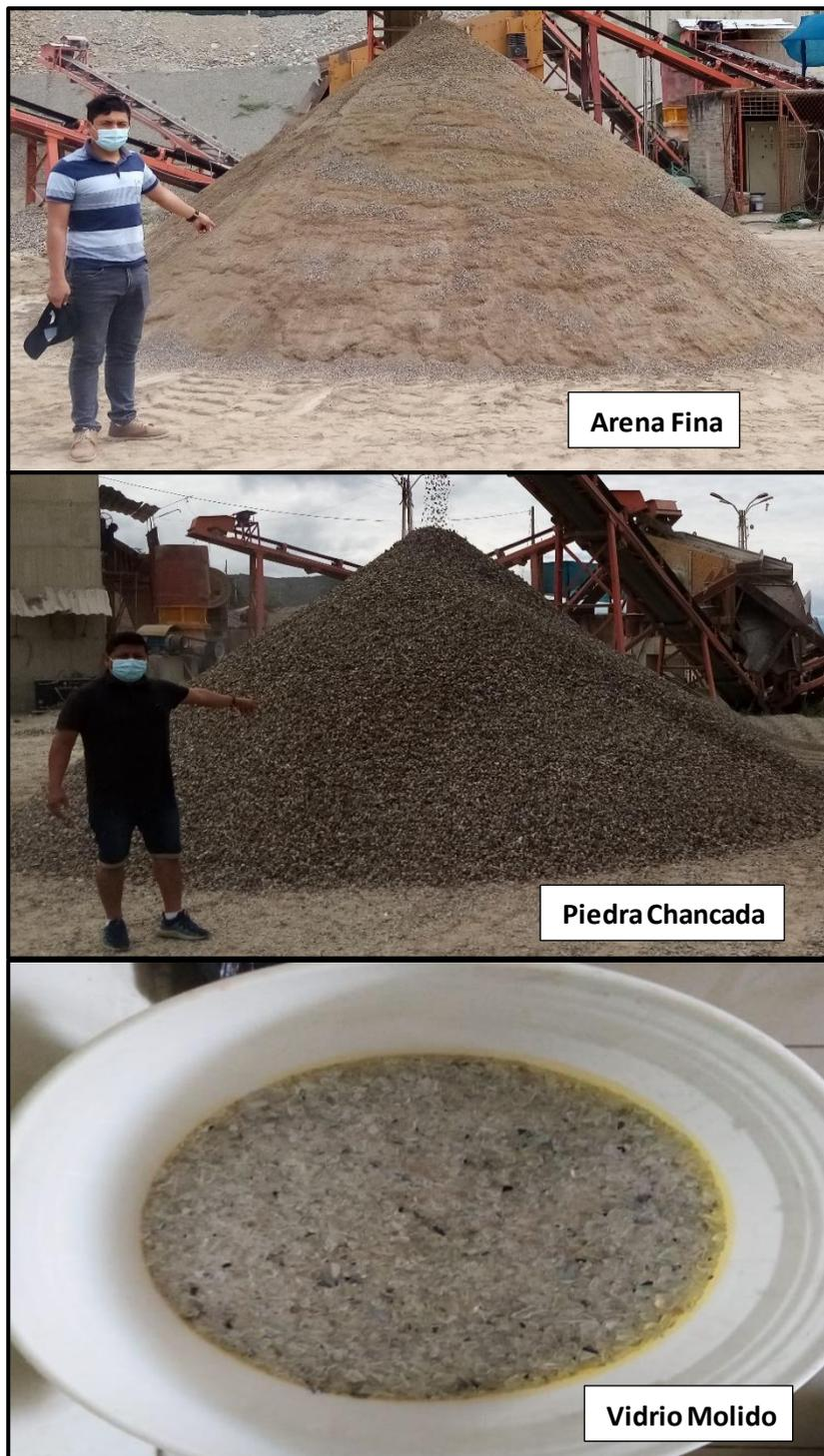
Posteriormente se realiza la mezcla, utilizando la metodología del ACI-211. Está basado en la obtención del proporcionamiento de la cantidad de materiales de acuerdo a la resistencia de diseño.
