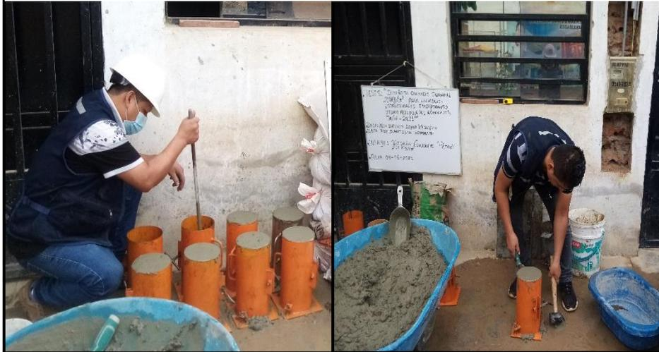
Se procede a realizar la fabricación de 8 probetas para cada diseño sumando un total de 24 testigos, en cuanto a la rotura se hará mediante el ensayo de la resistencia a la compresión a los 7, 14, 21 y 28 días respectivamente.
