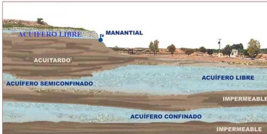
**Figura N° 3: Clasificación del acuífero en función de su Estructura**
