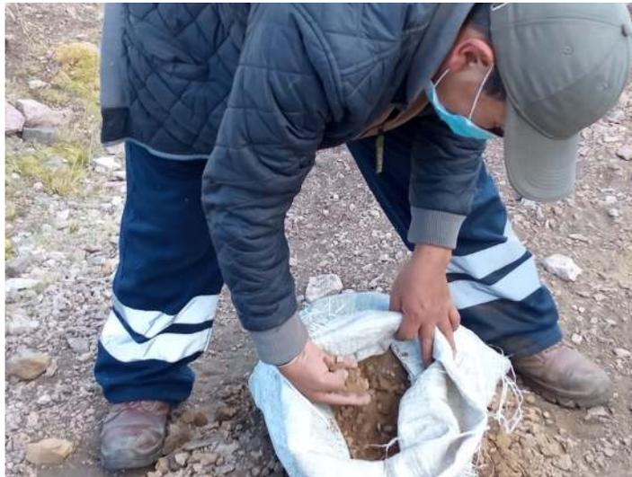
***Figura N° 17: Recojo de muestra de la cantera, para estudio de suelos, con la finalidad de conformar el núcleo del dique***
