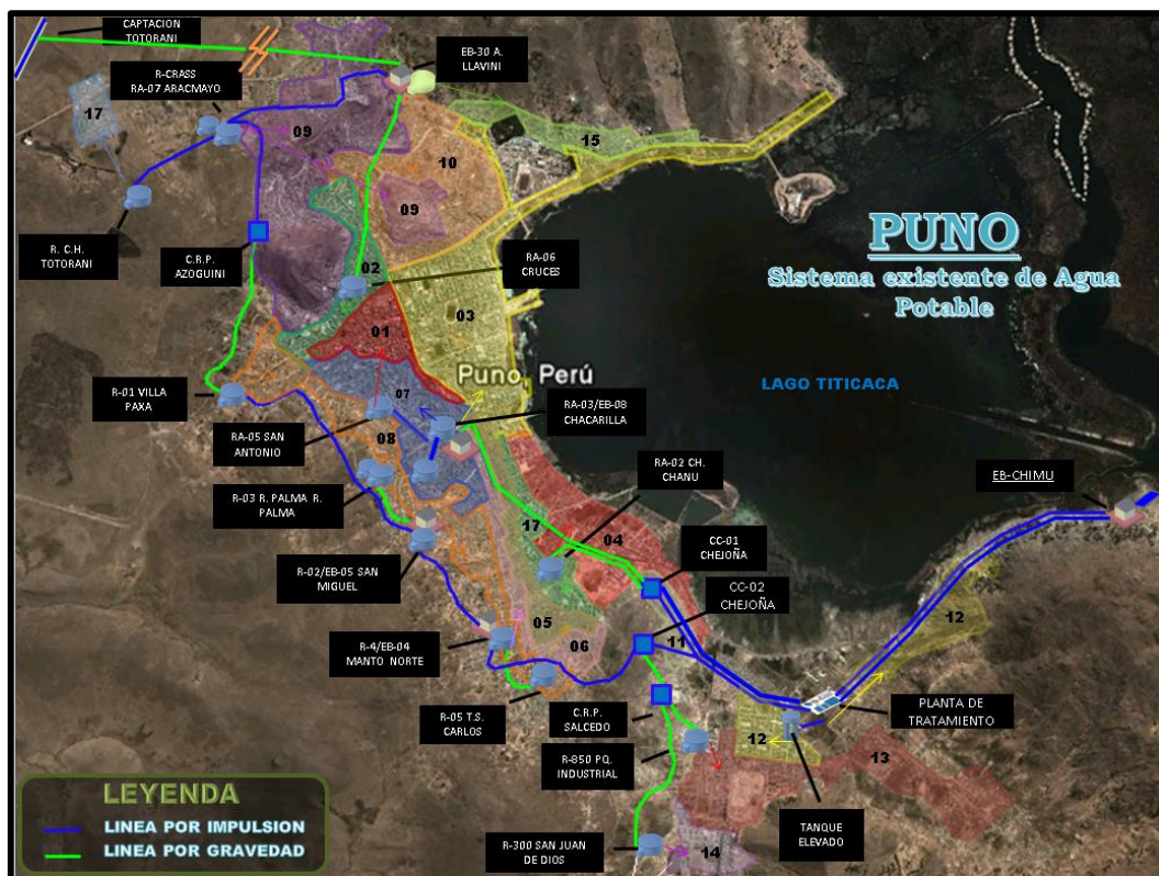
Figura 12. Ubicación de estaciones de re-bombeo y Reservorios
