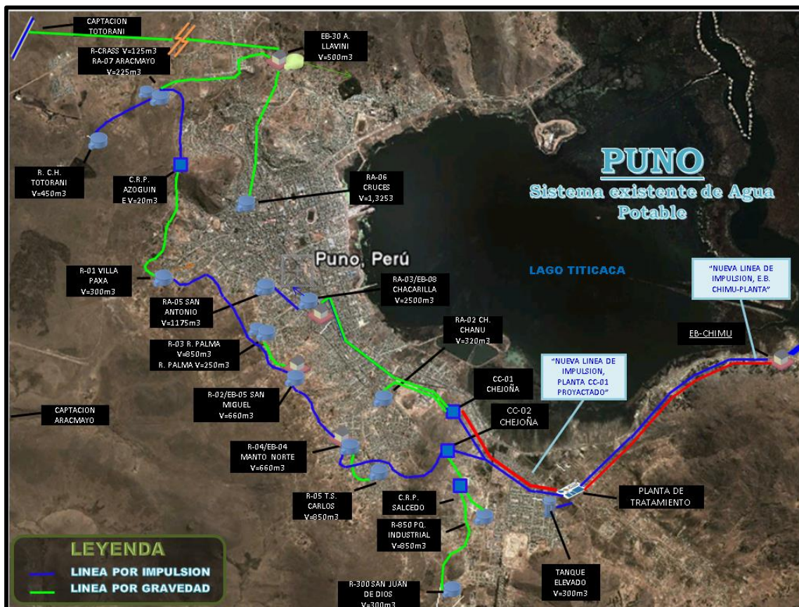
Figura 9. Configuración del sistema de abastecimiento de agua potable - Puno
