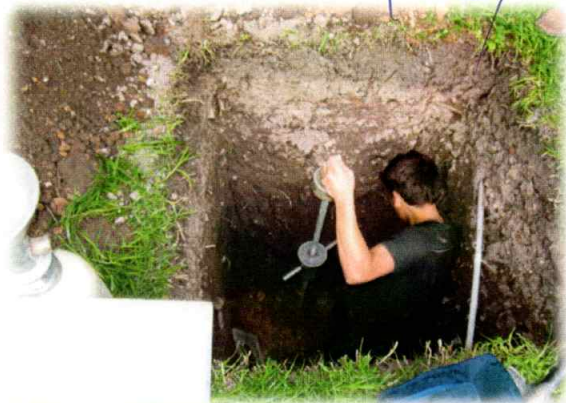
VISTA PANORAMICO DEL ENSAYO DE DPL
