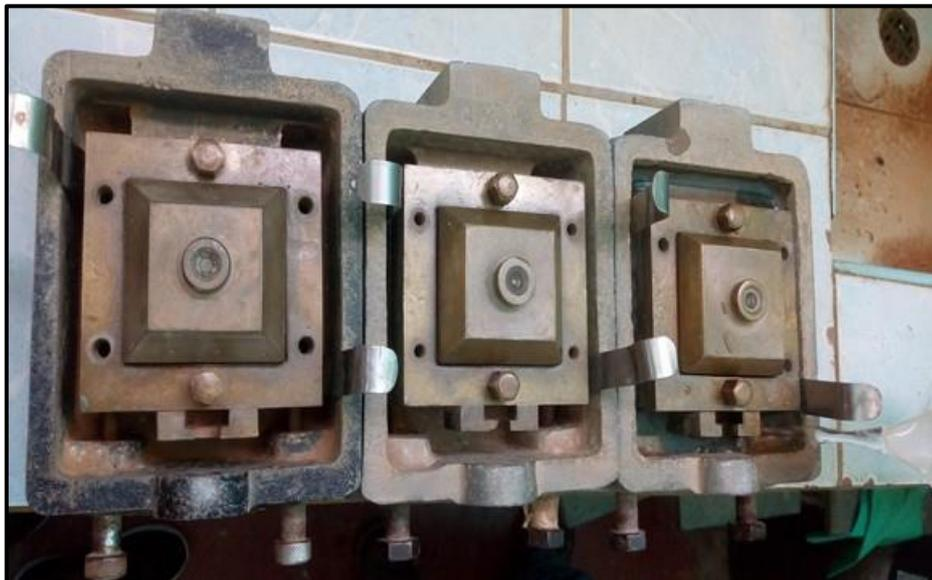
**Anexo - figura N° 23 Las Muestras Drenadas se Coloca en las Cajas de Corte Echas de Acero Inoxidable.**
