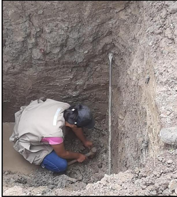
**Anexo - figura N° 03 Extracciones de Muestras Alteradas e Inalteradas.**
