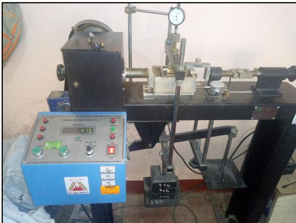
**Anexo - figura N°25 Se Aplica la Carga Vertical y se Coloca el Dial para Determinar el Desplazamiento se debe Incluir el peso del Pistón de Carga y la Mitad de la Caja Superior de las Cargas Verticales.**
