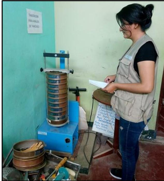
**Anexo - Figura N° 07 En La Tamizadora Motorizada Hacemos el Procedimiento, la Cual su Movimiento Orbital Facilita la Gradación ya que Dicha Muestra son Separadas por Tamices.
