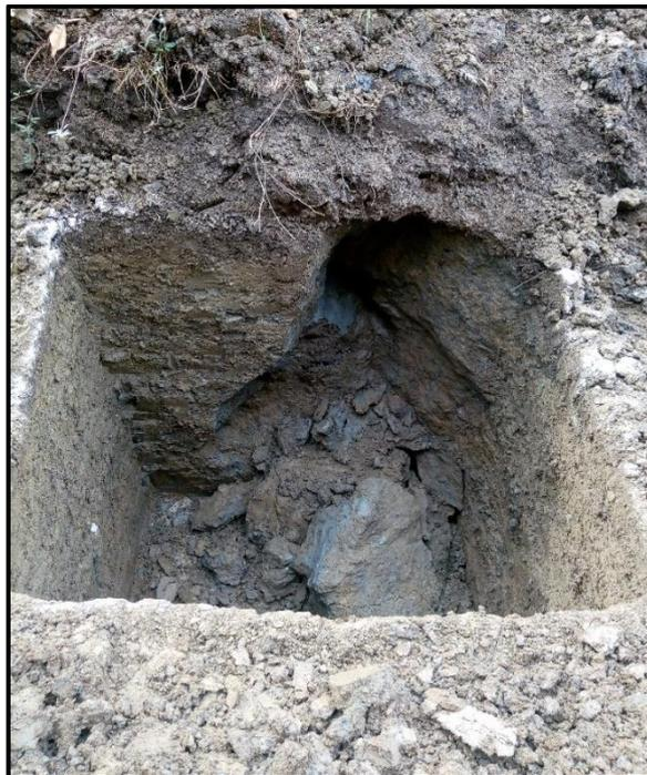
**Anexo – Figura N° 02 Excavación de Calicata en un Área de 1m<sup>2</sup> x 2m de Profundidad.**
