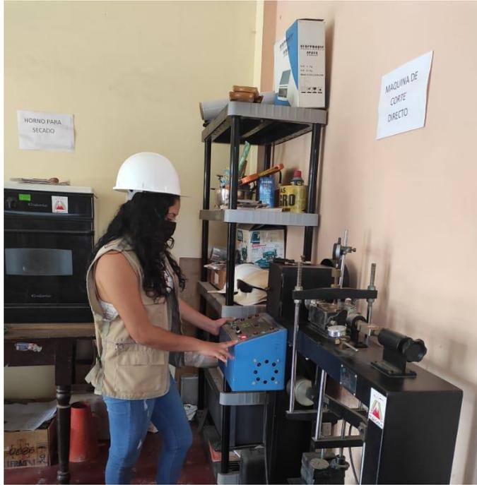
**Anexo - figura N°26 Recolección de datos del ensayo de corte directo**
