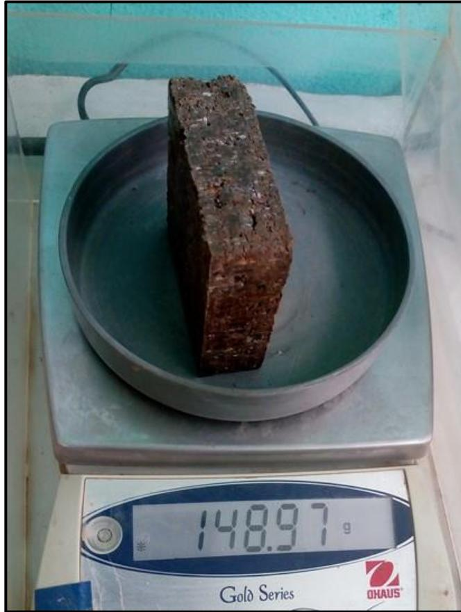
**Anexo - Figura N° 22 Se Pesa la Muestra que se Extrae de la Caja de Corte.**
