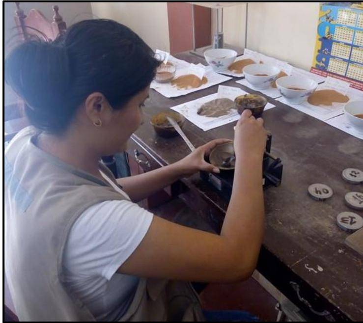
**Anexo - figura N° 11 Se Retira la Porción de la Pasta, con un Peso Aproximado de 10 gr de la Parte donde se Produjo la Unión, a Continuación, Anotamos los Datos en la Planilla.**
