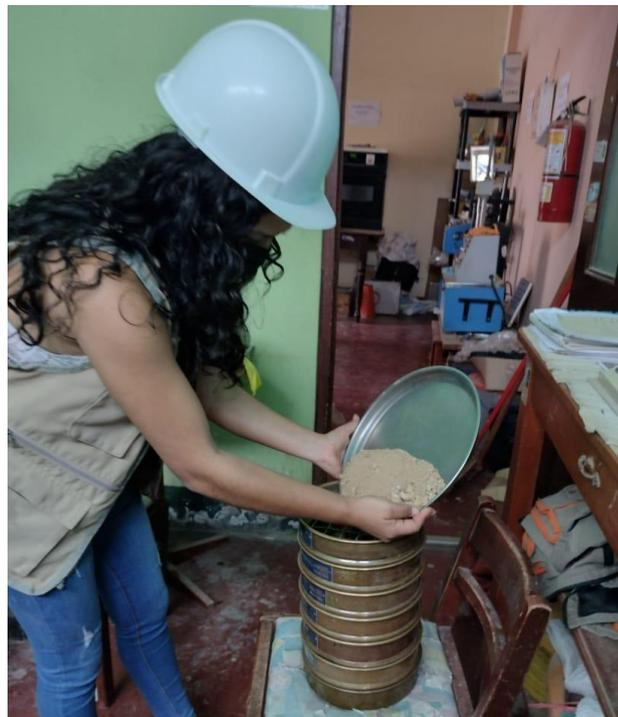
**Anexo - figura N° 08 Peso Granulométrico de cada Muestra Retenido en Cada Tamiz.
