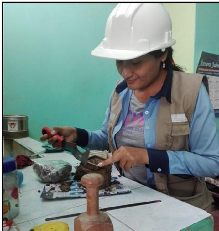
**Anexo - Figura N° 20 Corte de Muestra, en este Caso Utilizamos un Molde de 36cm<sup>2</sup> para hacer el Corte de Muestra.**
