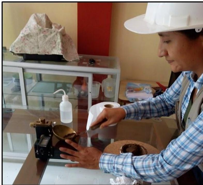
**Anexo - figura N° 10 Ensayo del límite líquido, la Copa de Casa Grande, se Coloca en la Cuchara una Porción de Suelo; en el Punto de Mayor Altura Debe Tener un Espesor de 10 mm.**
