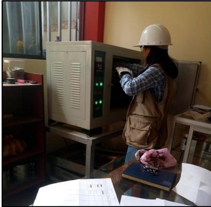
**Anexo - Figura N° 05 Colocación de Respectivas Muestras al Horno a una Temperatura de 110 Grados por un Promedio de 24 Horas Como Especifica la Norma.**
