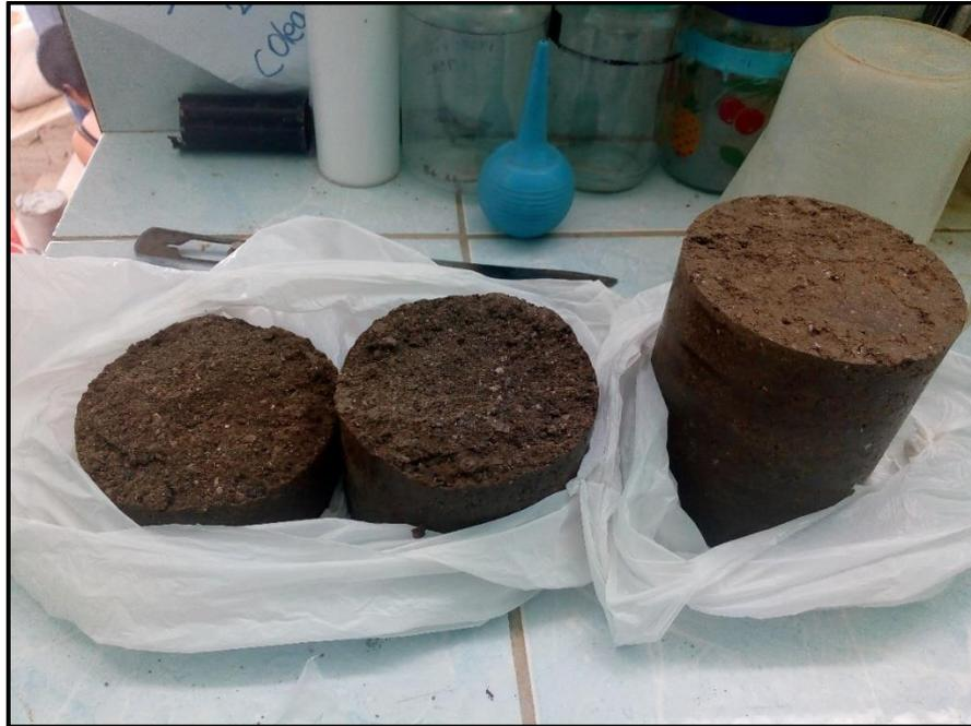
**Anexo - Figura N°19 Muestras de los moldes de Compactación de Suelo Natural, Cemento + Arena**
