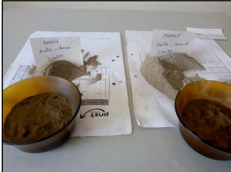
**Anexo - figura N° 09 Límites de Consistencia, Mezcla de Suelo Natural Arcilla, Material Granular (Arena) y Aditivo (Cemento).**
