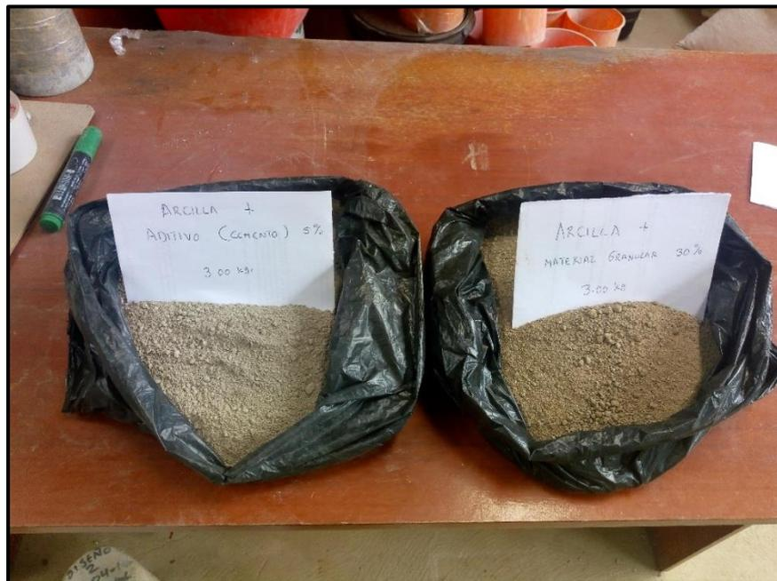
Anexo - Figura N° 14 Mezcla de Cemento y Arena, la Mezcla se hace con un Porcentaje de Suelo Natural Arcilla más Aditivo Cemento con el 5% y la Mezcla de Suelo Natural más Material Granular Arena con el 30%.
