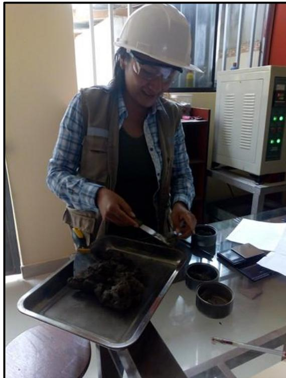
**Anexo - figura N° 04 Realizamos Muestras para el Contenido de Humedad.**
