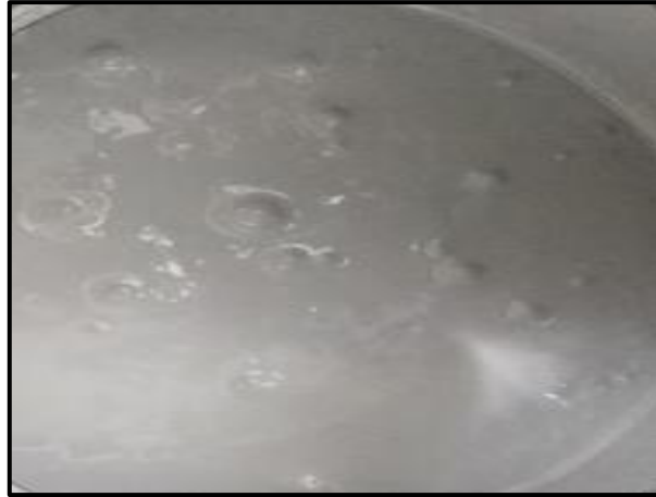
Figura 6: Recubrimiento epoxico con espuma Fuente: Elaboración propia
