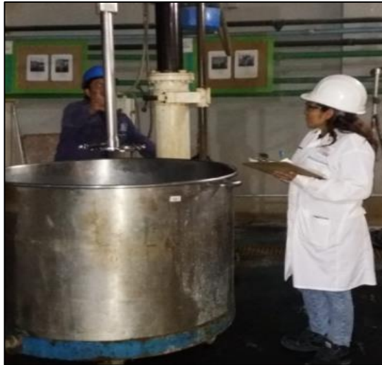
Figura 10: Proceso de fabricación con equipo Cowles Fuente: Elaboración propia
