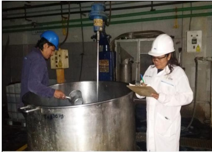
Figura 4: Equipo con paleta de élice para dispersión Fuente: Elaboración propia
