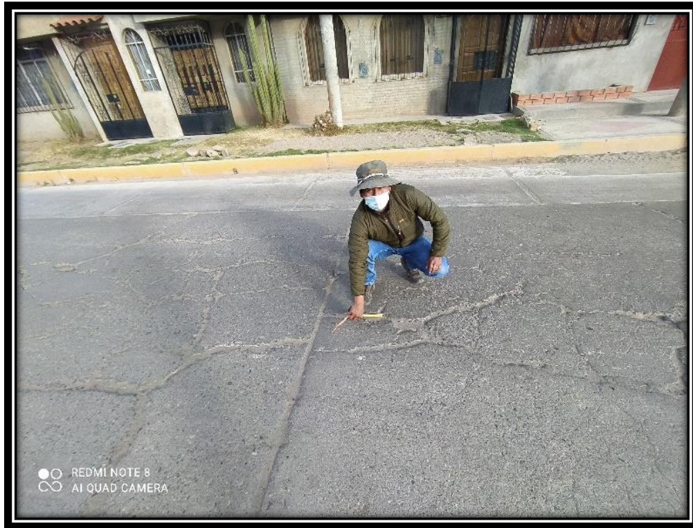
Figura. 33 Fotografía de la medición de fallas aplicando método PCI
