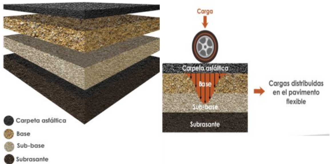
Figura. 2 Sección típica de un pavimento flexible
