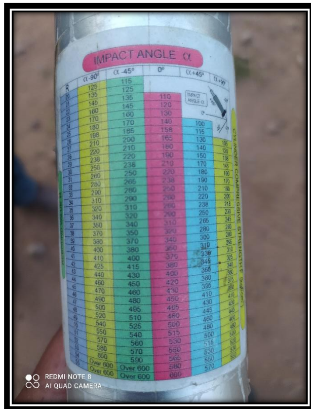
Figura. fotografía ensayo con esclerómetro
