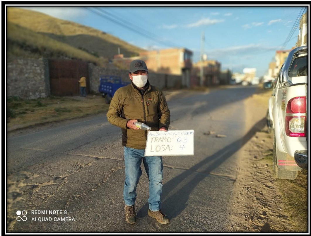
Figura. fotografía ensayo con esclerómetro
