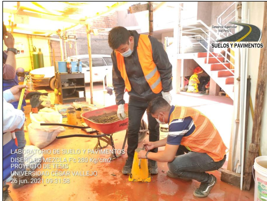
Figura 17. Enrasado del material en el cono de abrams
