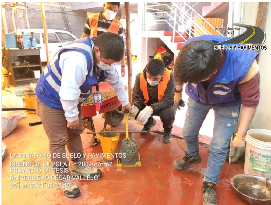
Figura 18. Medida del asentamiento del concreto
