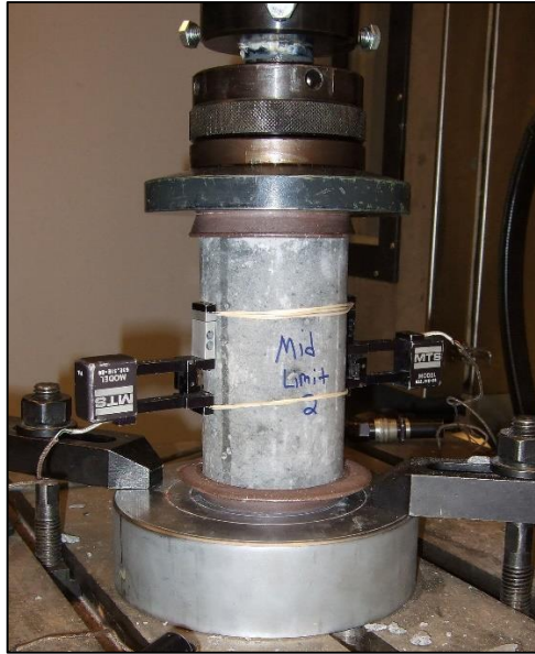
Figura 7. Probeta cilíndrica sometida al ensayo de compresión Fuente. (Imcyc, 2012, p. 20)
