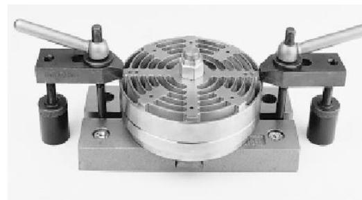
Figura N°6: Válvula montada en prensa
