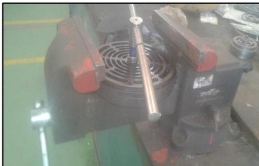
Armado y desarmado de válvulas en prensa tornillo de banco
