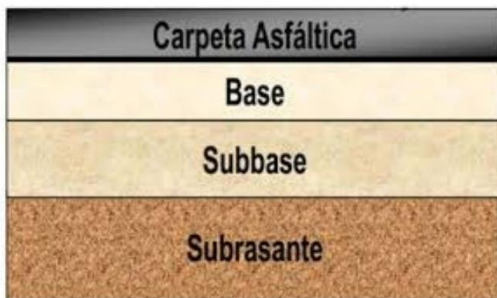
Figura 1: Estructura de Pavimento flexible.
