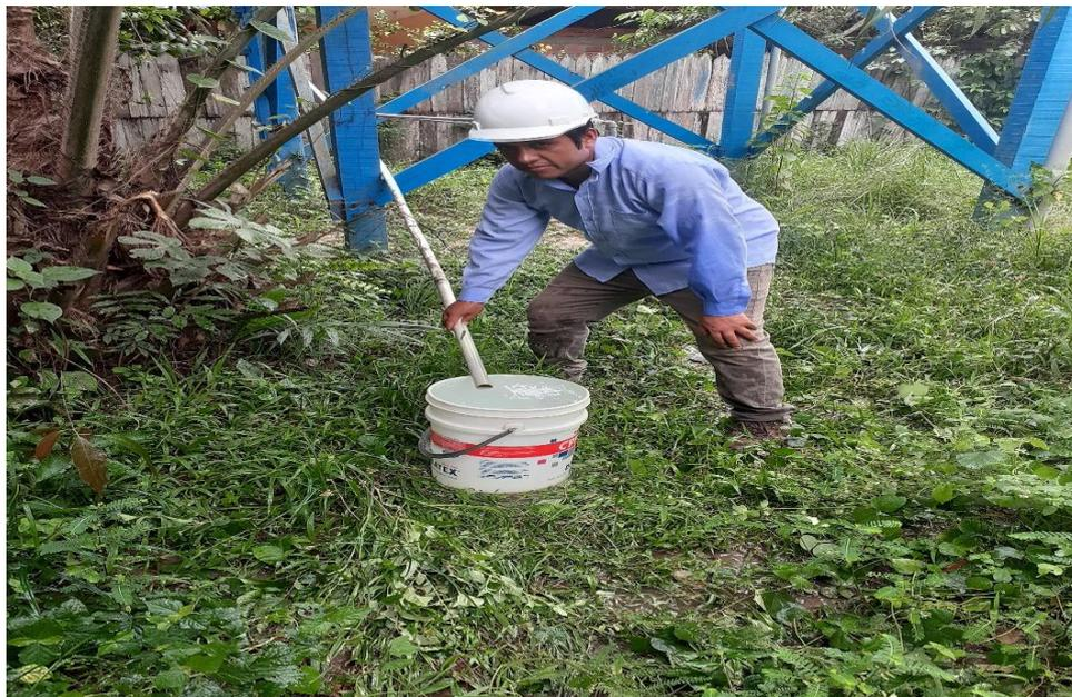
**Imagen 04.** Se muestra el procedimiento del cálculo del caudal de la línea de impulsión.
