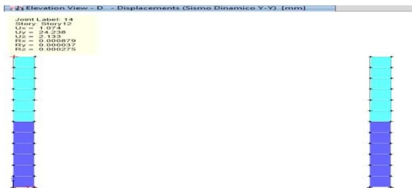
**Figura 33.** Desplazamientos máximos en el eje “J” según el análisis lineal dinámico.
