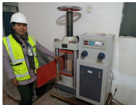
Descripción: rotura de probetas de suelo cemento.
