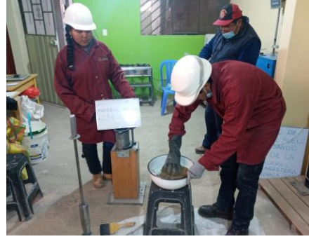
Descripción: ensayo de probetas de suelo cemento.
