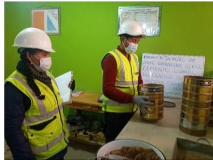
Descripción: tamizado de los agregados para el ensayo de granulometría.
