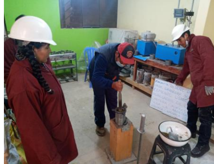
Descripción: chuseado del material para luego compactarlo.
