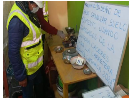
Descripción: ensayo de límites de consistencia.
