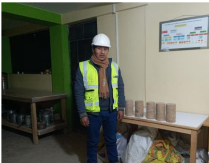
Descripción: probetas de suelo cemento listos para su rotura.
