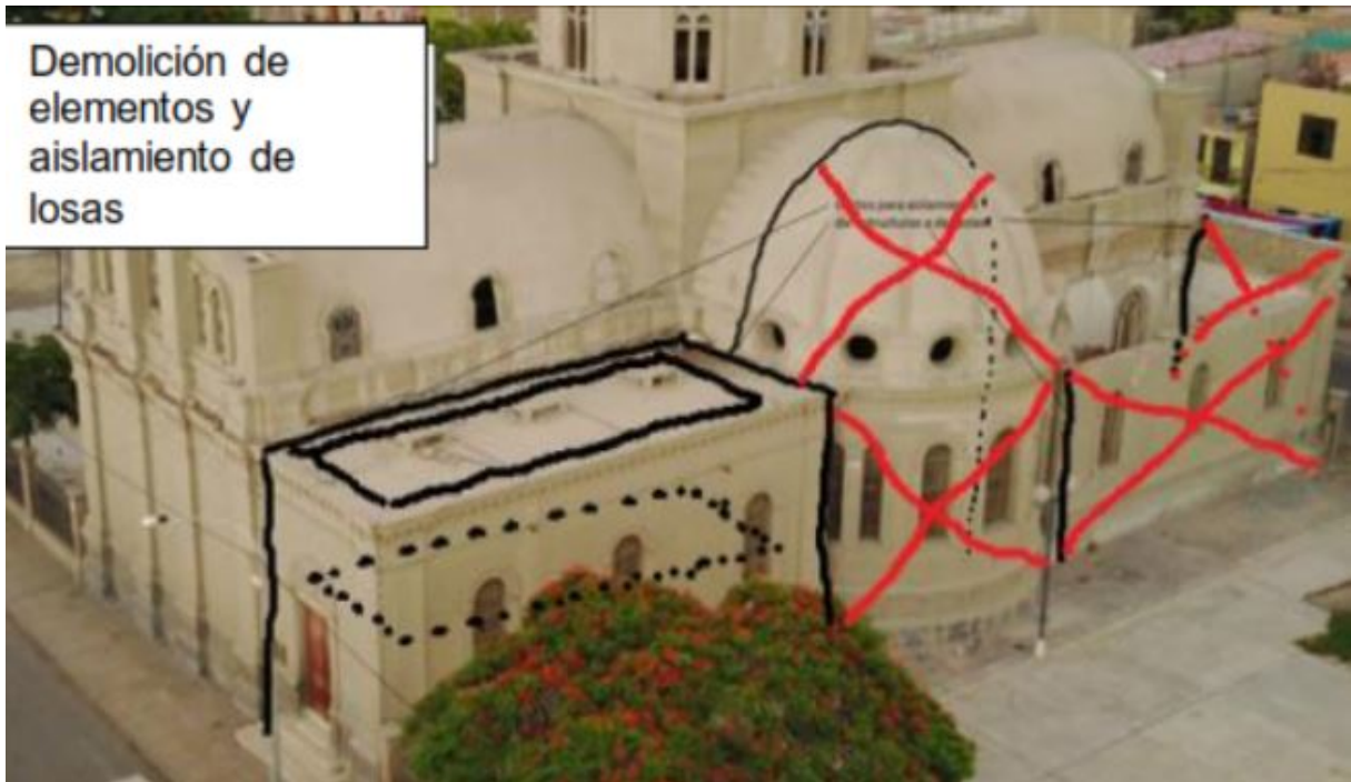
Figura 4.19: Esquema 2 de demolición
