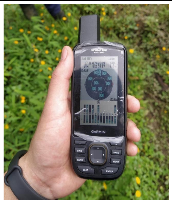
Fotografía N° 2: En la imagen se muestra el equipo GPS que hemos utilizado para nuestra Georreferenciación.
