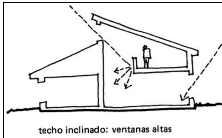
Figura 9: Ingreso de luz en el interior: (Van, J., 2002)
