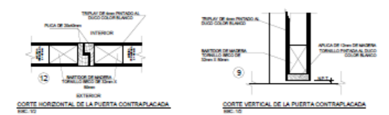
CORTE HORIZONTAL DE LA PUERTA CONTRALAMINADA
