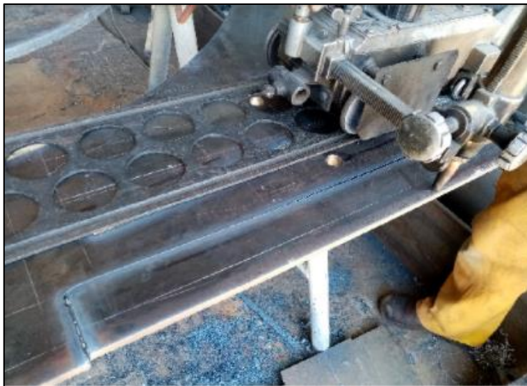
Foto 6. Cortado de lámina 1
