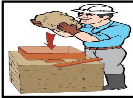
Figura 2. Incorporación de la mezcla al molde.
