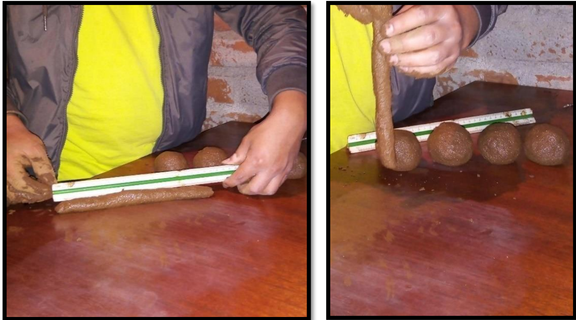
Figura 9. Prueba de bolas y rollos de suelo humedecido in situ
