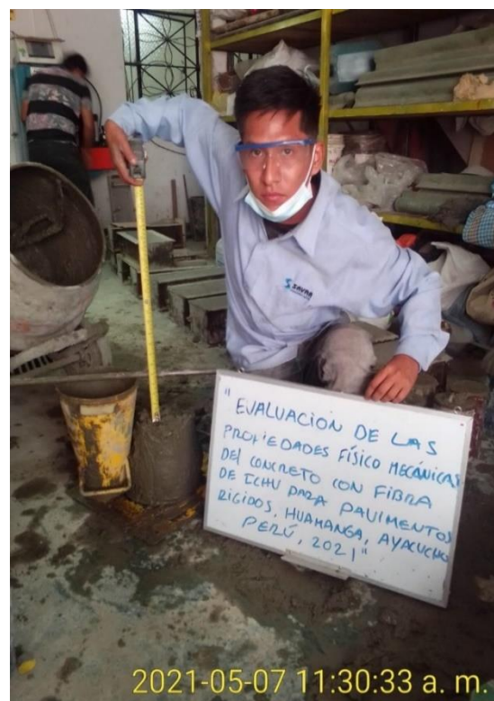
Figura N° 6: Medición del asentamiento
