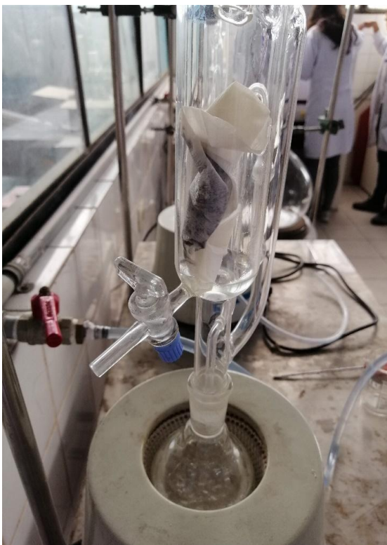
Figura 3 Extracción petróleo con Soxhlet
