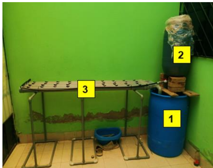
Figura 02: Recorrido del agua en el sistema acuapónico en la ciudad de Chiclayo
