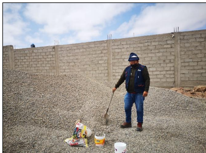
Ilustración N°2: Extracción de muestra de agregado grueso de la cantera San Pablo Ilo
