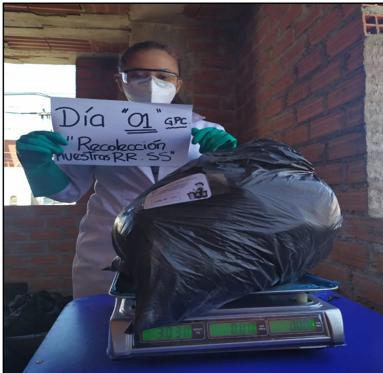
Figura 30: Pesado de las bolsas de muestras de residuos sólidos de las viviendas participantes para determinar la GPC
