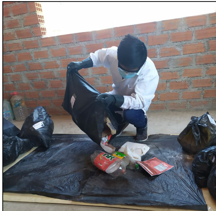
Figura 34: Vaciado de las muestras de las viviendas participantes para determinar la composición porcentual.
