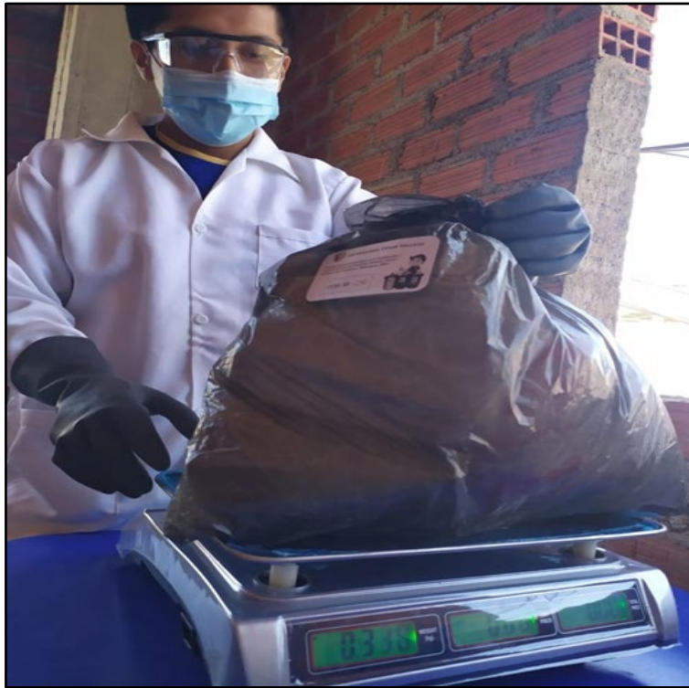
Figura 29: Pesado de las bolsas de muestras de residuos sólidos de las viviendas participantes para determinar la GPC
