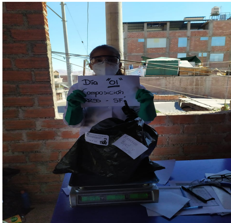
Figura 42: Pesado de las bolsas según sus características físicas, para determinar la composición porcentual.
