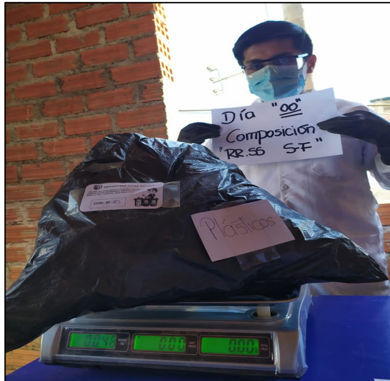
Figura 37: Pesado de las bolsas según sus características físicas, para determinar la composición porcentual.
