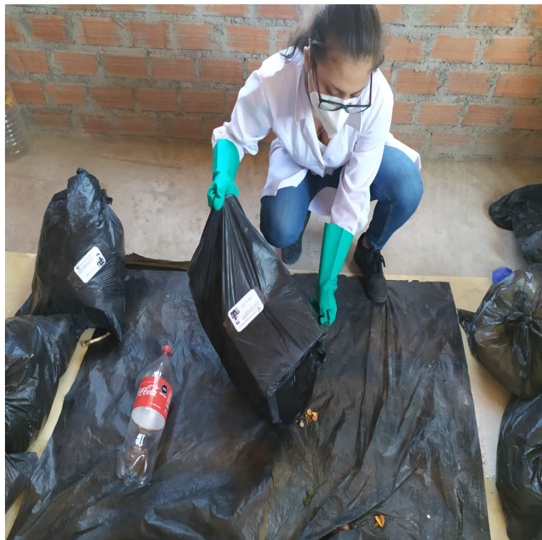
Figura 39: Vaciado de las muestras de las viviendas participantes para determinar la composición porcentual.
