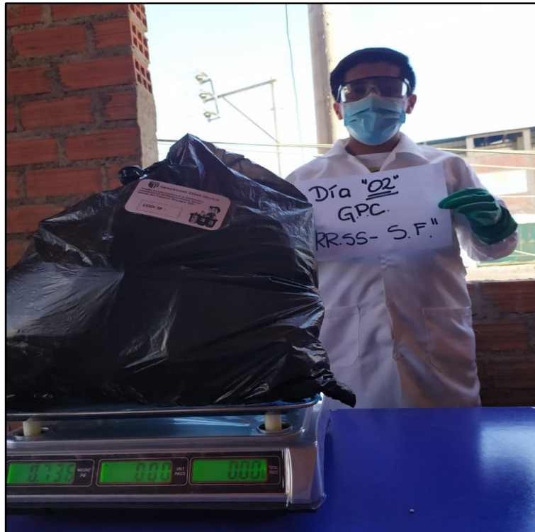
Figura 31: Pesado de las bolsas de muestras de residuos sólidos de las viviendas participantes para determinar la GPC
