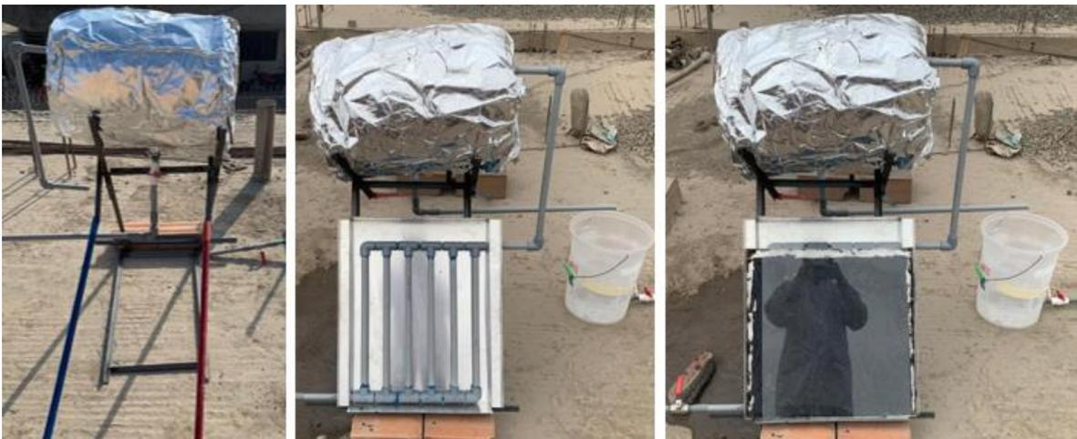
*Figura 23.* Colector de placa plana de biopolímero con grafeno reducido
