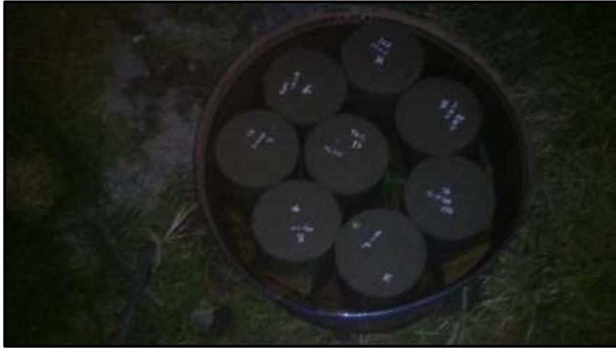
*Figura 21* Curado de moldes de concreto
