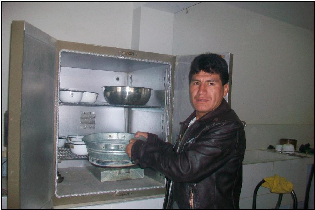
*Figura 13* Secado de los agregados
