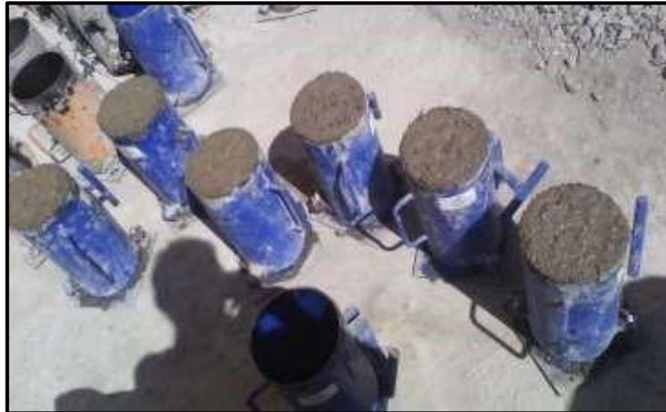
*Figura 20* Moldeo de probetas de concreto
