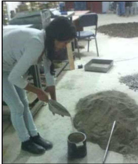
*Figura 12 Ensayo de peso unitario del Agregado fino*
