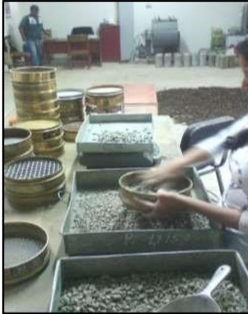
*Figura 7 Tamizado de agregado grueso*
