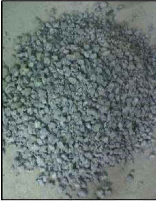
*Figura 19* Agregado grueso reciclado
