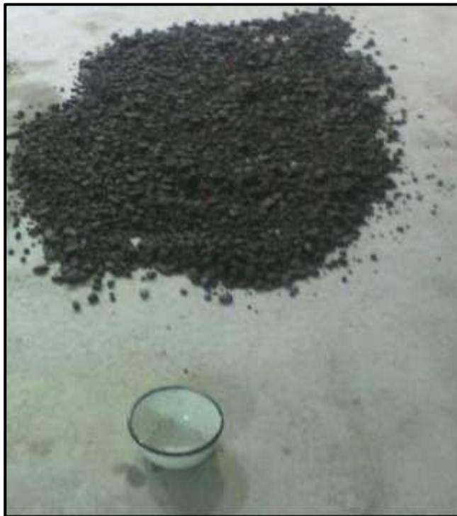
*Figura 8 Toma de muestra para ensayo de contenido de humedad*
