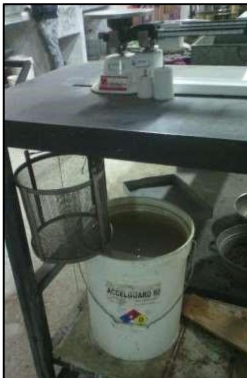
*Figura 10* Ensayo de peso específico y porcentaje de absorción de agregado grueso natural
