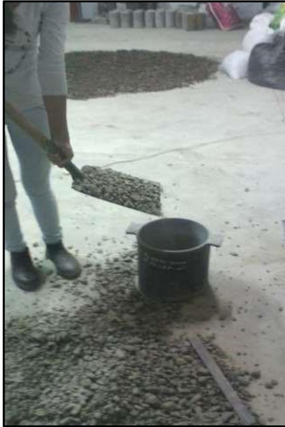
*Figura 9* Ensayo de peso unitario de agregado grueso natural
