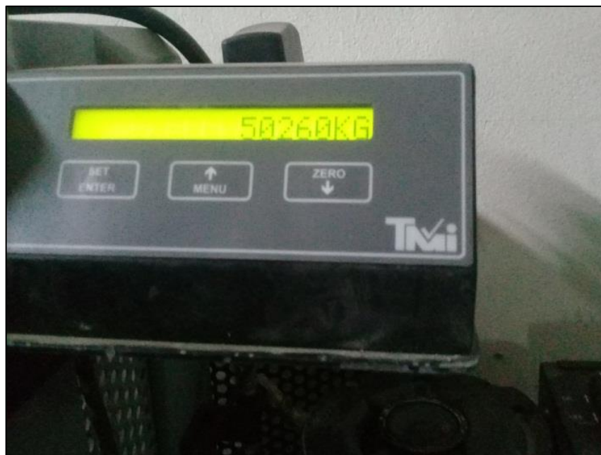
Fotografía N°19: Resistencia a la compresión de la muestra con sustitución al 20%, 28 días.
