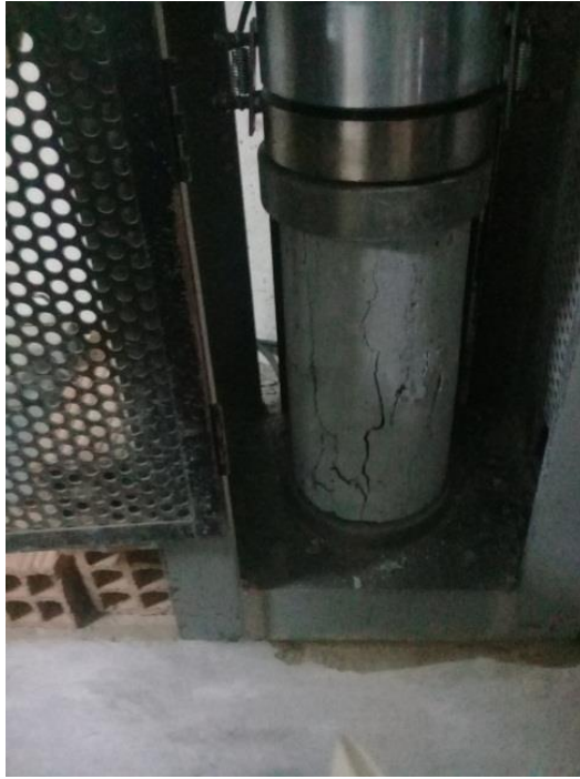
Fotografía N°22: Prueba a la resistencia a la compresión de la muestra patrón.
