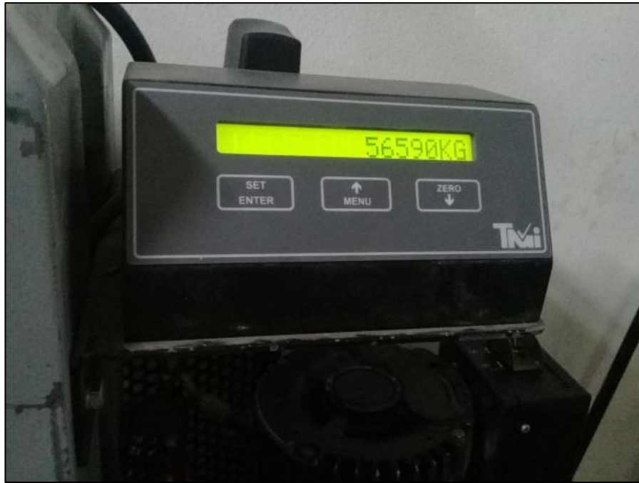
Fotografía N°20: Resistencia a la compresión de la muestra con sustitución al 25%, 28 días.
