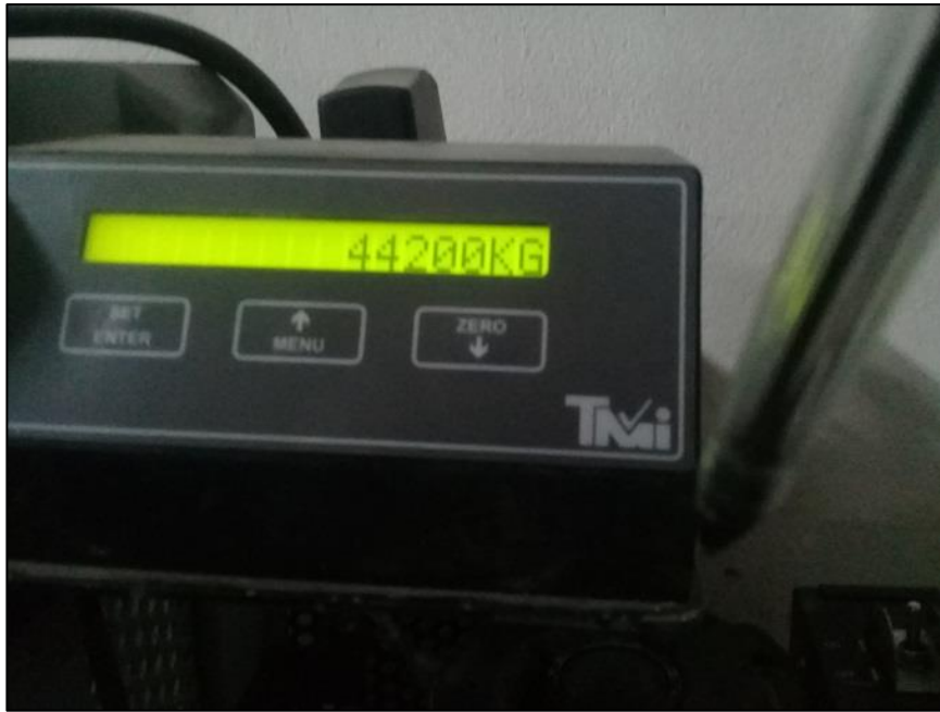
Fotografía N°16: Resistencia a la compresión de la muestra con sustitución al 25%, 14 días.
