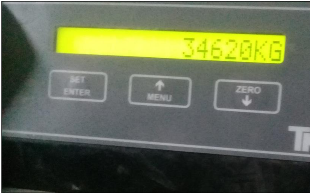
Fotografía N°14: Resistencia a la compresión de la muestra patrona 14 días.
