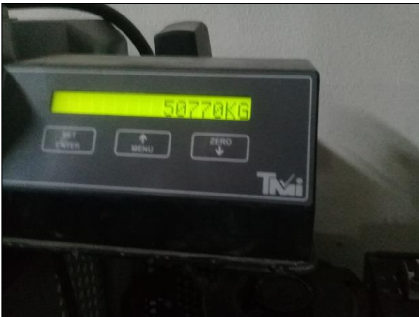
Fotografía N°17: Resistencia a la compresión de la muestra con sustitución al 30%, 14 días.
