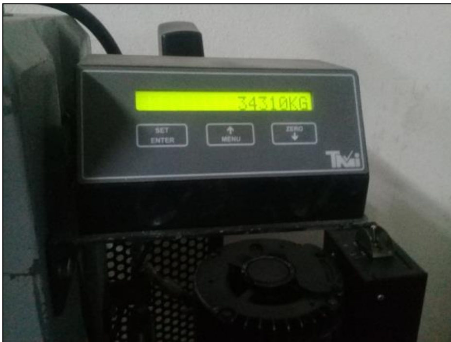
Fotografía N°11: Resistencia a la compresión de la muestra con sustitución al 20%, 7 días.
