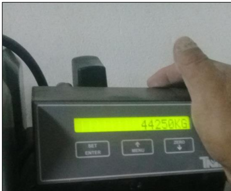
Fotografía N°13: Resistencia a la compresión de la muestra con sustitución al 30%, 7 días.
