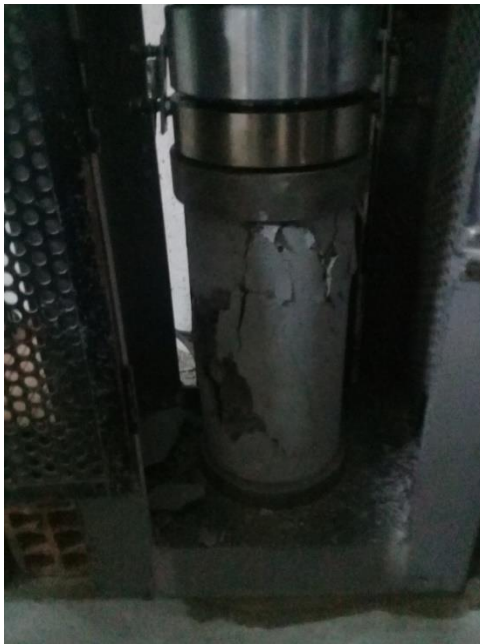
Fotografía N°23: Prueba a la resistencia a la compresión de la muestra con sustitución al 20%.
