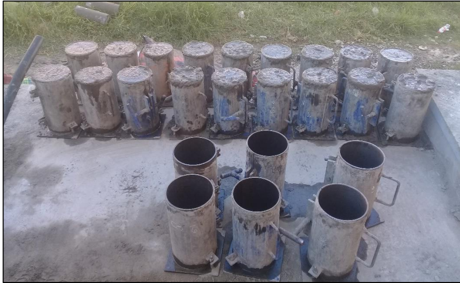
Fotografía N°08: Llenado de la mezcla en las probetas metálicas.
