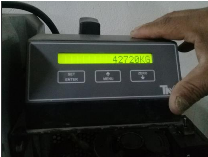
Fotografía N°18: Resistencia a la compresión de la muestra patrona 28 días.
