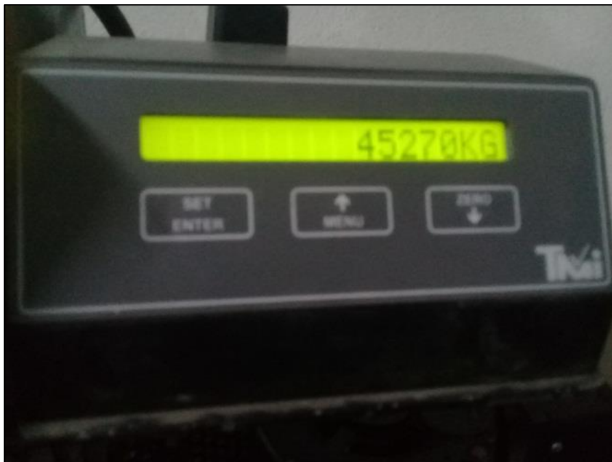
Fotografía N°15: Resistencia a la compresión de la muestra con sustitución al 20%, 14 días.
