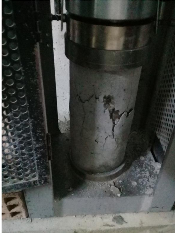
Fotografía N°24: Prueba a la resistencia a la compresión de la muestra con sustitución al 25%.
