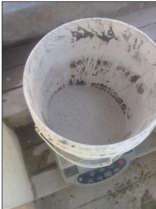
Fotografía N°05: Polvo de Cuarzo pesado antes de ser mezclado.
