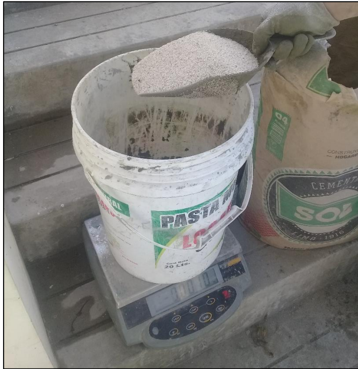
Fotografía N°04: Pesado del polvo de cuarzo según diseño de mezcla.
