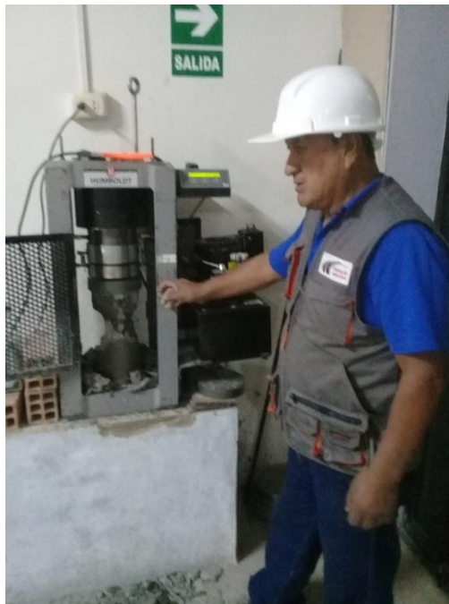
Fotografía N°25: Prueba a la resistencia a la compresión de la muestra con sustitución al 30%.
