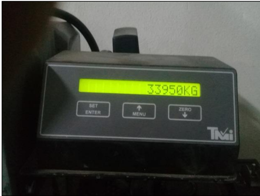
Fotografía N°12: Resistencia a la compresión de la muestra con sustitución al 25%, 7 días.
