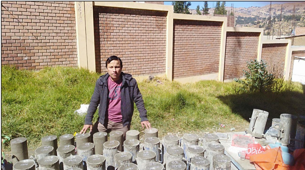
Fotografía N°09: Desencofrado de las muestras antes de ser curados.
