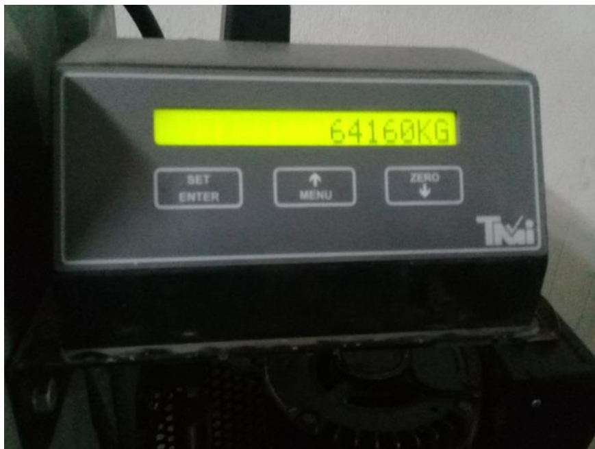
Fotografía N°21: Resistencia a la compresión de la muestra con sustitución al 30%, 28 días.
