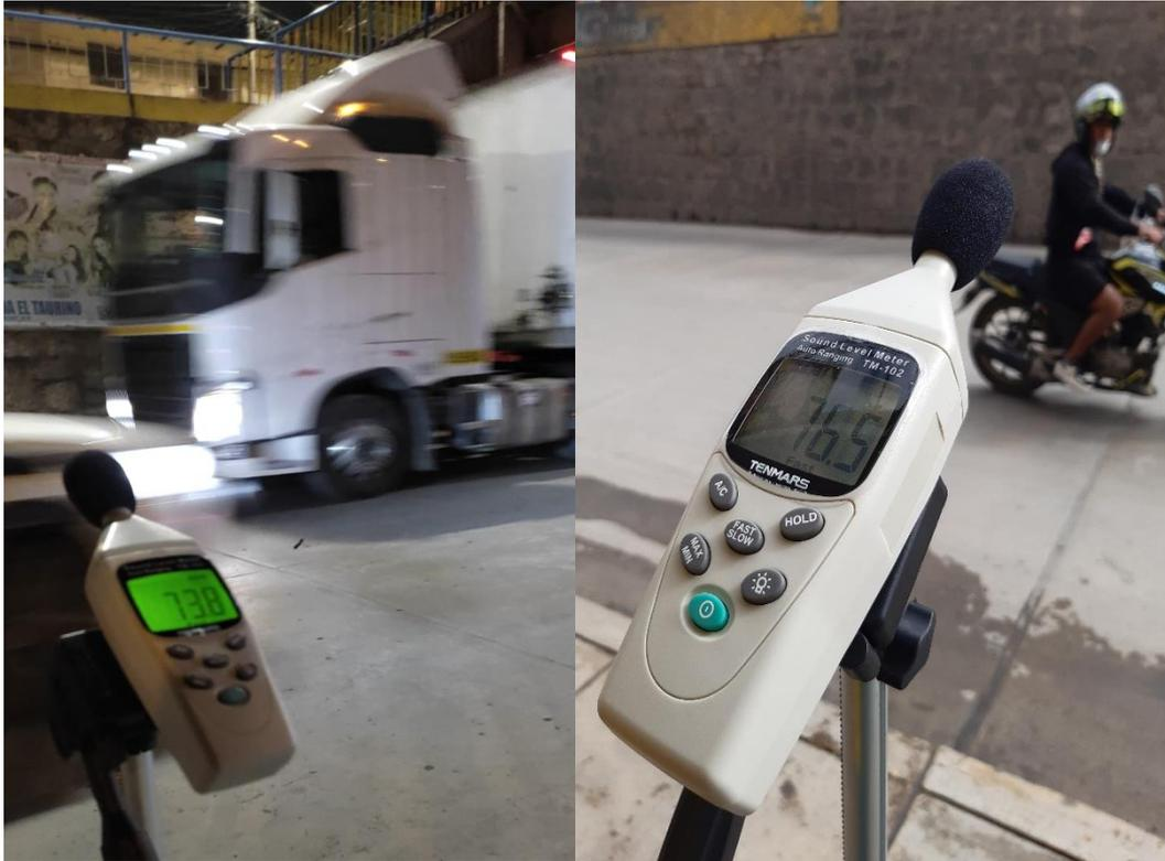
*Fotografía 3: Recolección de datos obtenidos mediante el Sonómetro en horario Diurno y Nocturno en los 5 puntos de la Av. Venezuela*
