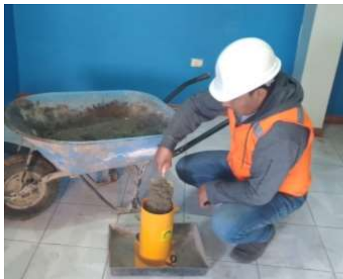
FOTOGRAFÍA N° 12: Colocación de la mezcla en el molde – 1ra capa
