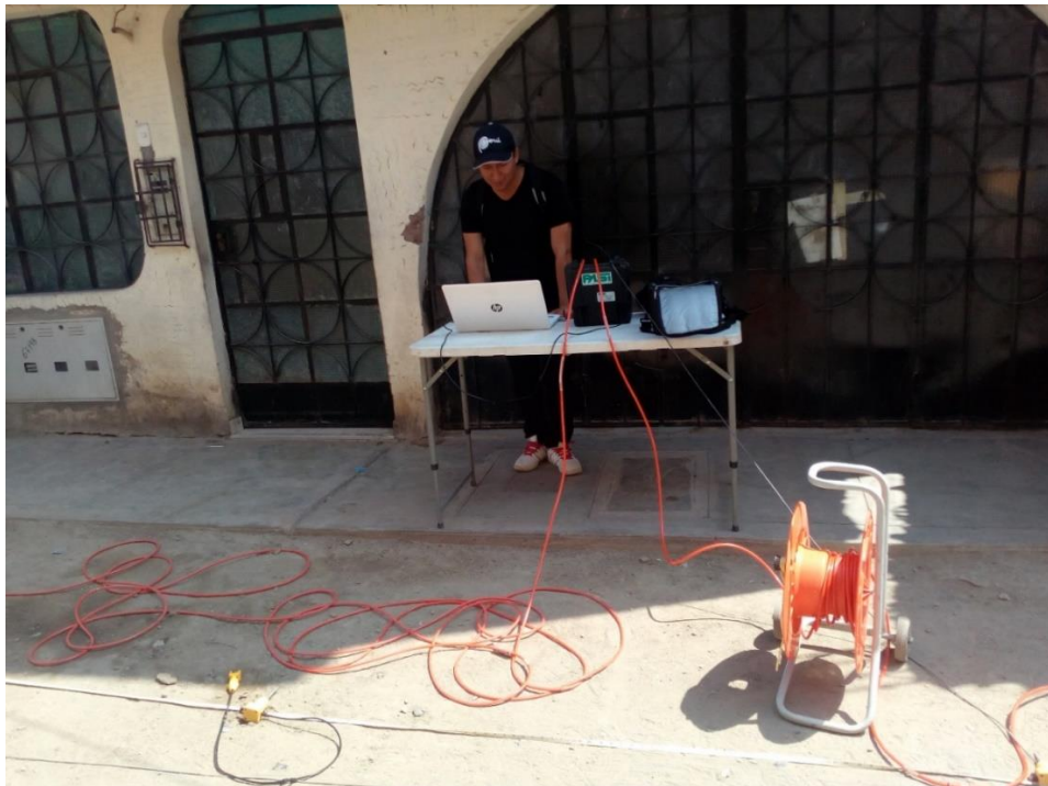
Ensayo MASW en el sitio SC2
