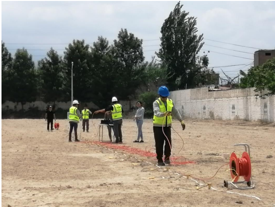
Fotografía de la línea de geófonos para el ensayo MASW en el sitio SC4
