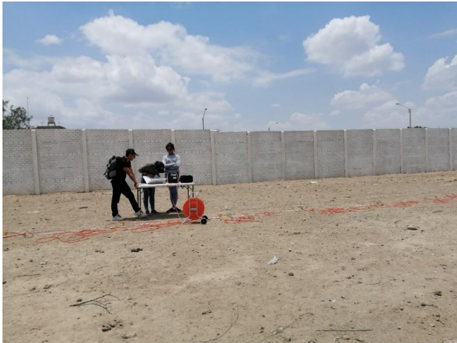
Fotografía del ensayo MASW en el sitio SC5
