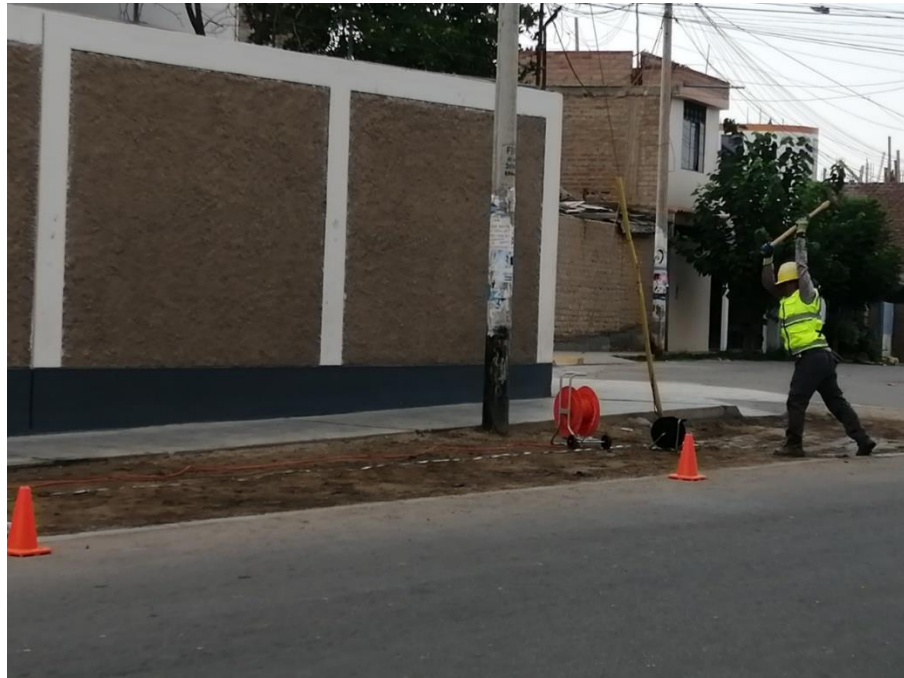
Figura de un shoot del ensayo MASW en el sitio SC1
