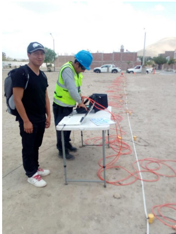
Fotografía del ensayo MASW en el sitio SC4
