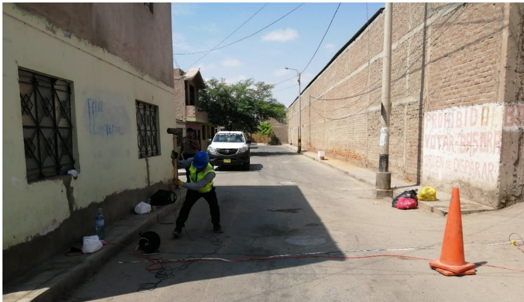
Fotografía de un shoot del ensayo MASW en el sitio SC2
