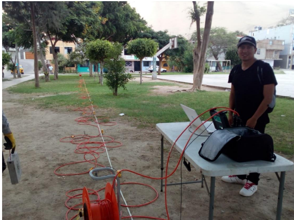
Fotografía del ensayo MASW en el sitio SC3
