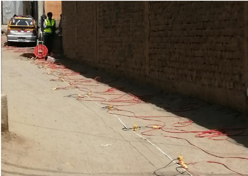
Fotografía de la línea de geófonos para el ensayo MASW en el sitio SC2
