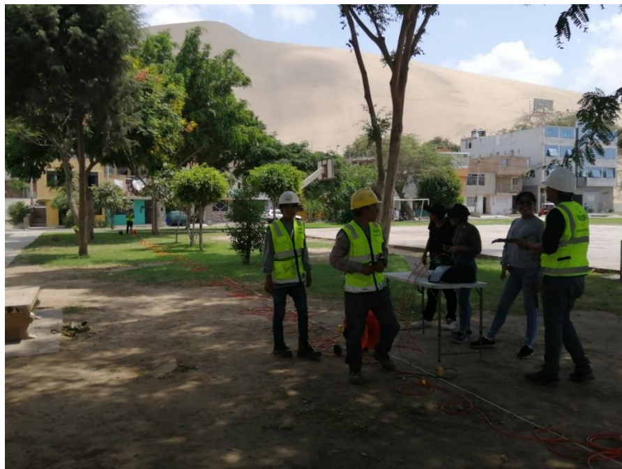
Fotografía de la línea de geófonos del ensayo MASW en el sitio SC3
