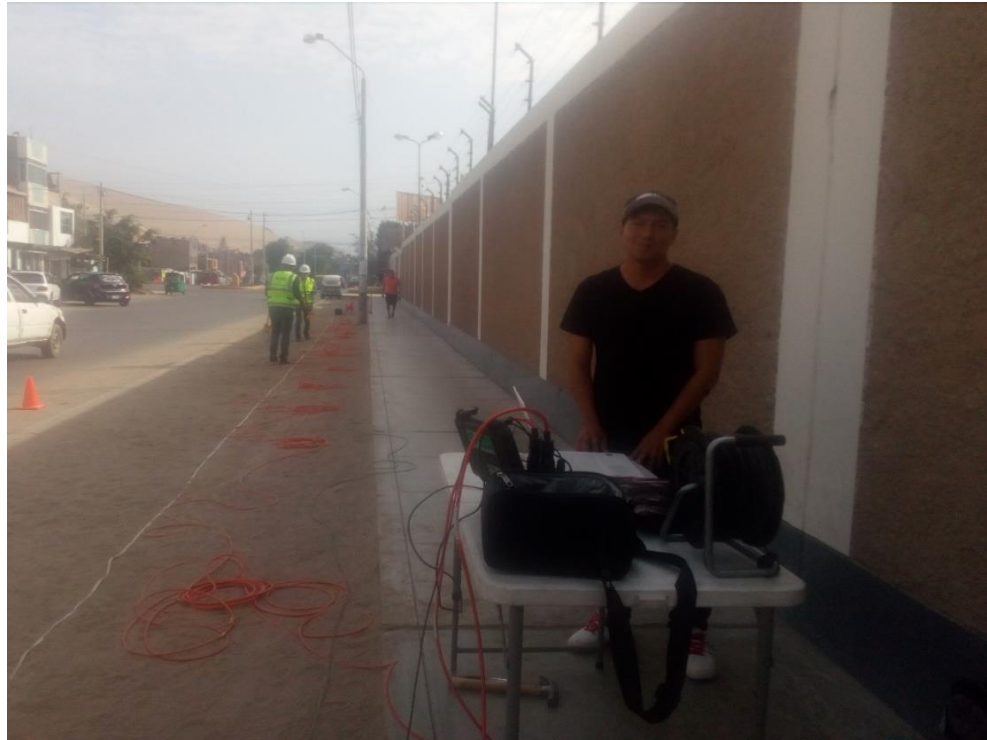
Fotografía del ensayo MASW en el sitio SC1
