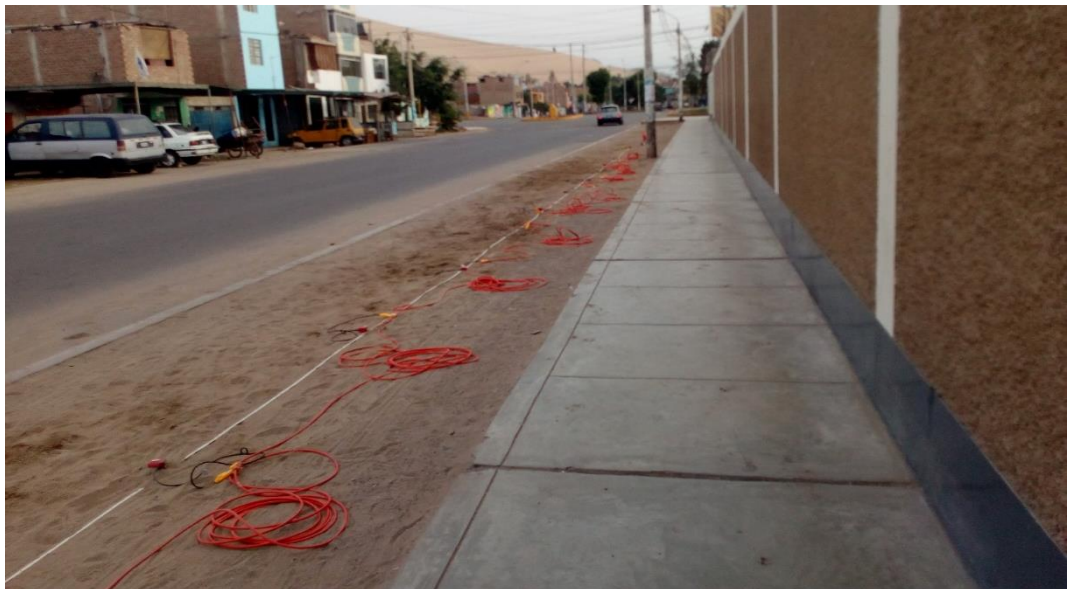
Fotografía de la línea de geófonos para el ensayo MASW en el sitio SC1
