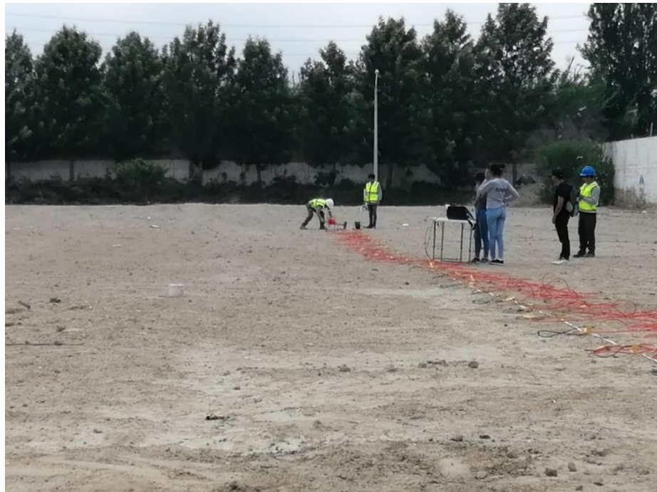
Fotografía de un shoot para el ensayo MASW en el sitio SC4
