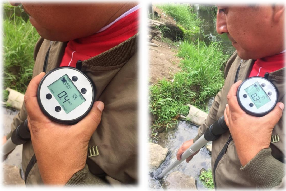
FIGURA N° 15: Aforo del canal de descarga del Vivero Forestal de Chimbote (una de las secciones del canal abierto)
