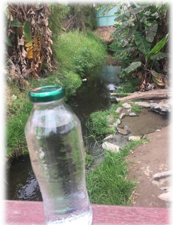
FIGURA N° 17: Toma de las muestras en el canal abierto de descarga, en un recipiente esterilizado
