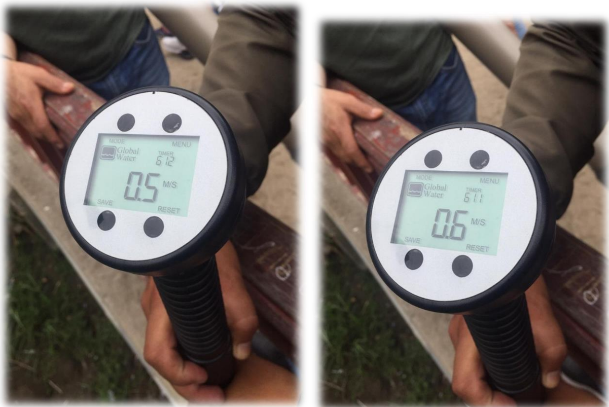
FIGURA N° 16: Aforo del canal de descarga del Vivero Forestal de Chimbote (una de las secciones del canal abierto)
